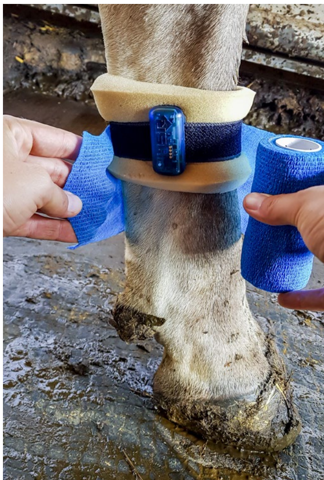
Abb. 3: Befestigung des Beschleunigungssensors am linken Hinterbein zur Erfassung des Liegeverhaltens und der Bewegungsaktivität (Foto: Joan-Bryce Burla, BLV).
