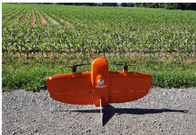
Fig. 1: Grand drone wingtra à décollage vertical. Sa vitesse minimale en vol est de 50 km/h et son altitude de survol de 60 m (photo Agroscope).
