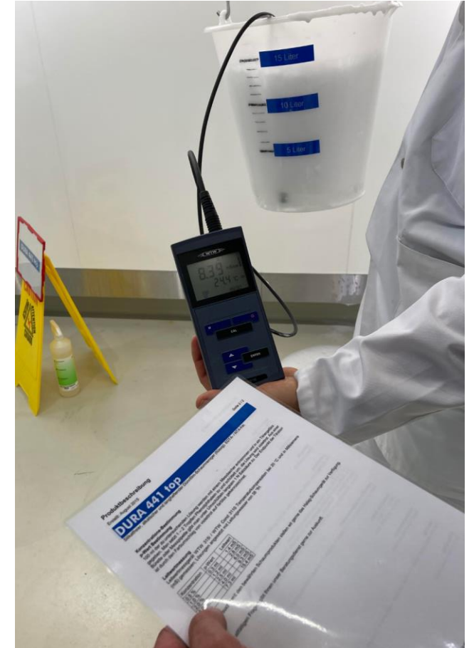
Das Halag-Datenblatt ermöglicht die Umrechnung zwischen mS, p-Wert und der Konzentration des Produkts in %.
