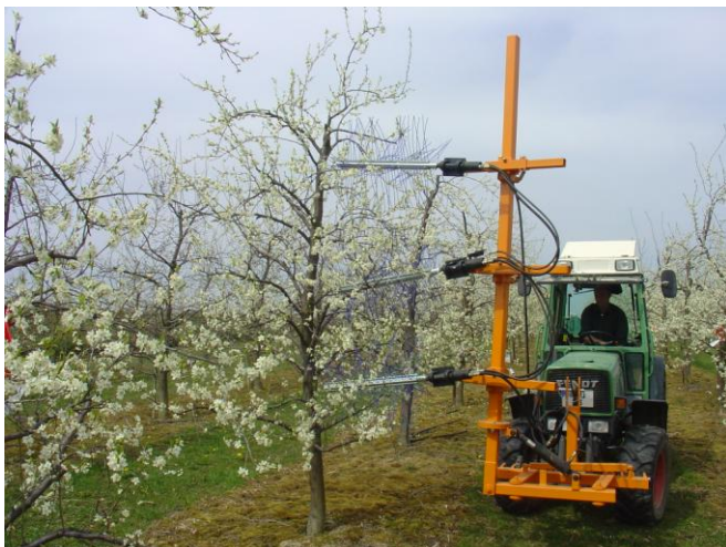
Abb 4: Die Ausdünnmaschine „Typ Bonn“ mit drei oder vier horizontalen, verstellbaren Spindeln eignet sich für grössere Baumformen und damit auch für Steinobst. (Foto: DLR Rheinpfalz)
