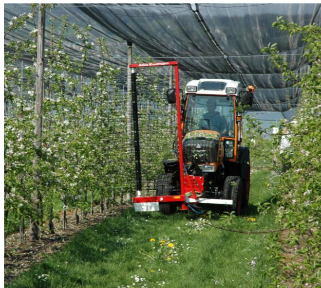
Abb. 1: Die Ausdünnmaschine „Tree-Darwin“. Einsatzzeitpunkt, Fahrgeschwindigkeit, Drehzahl der Spindel und Anzahl der Fäden bestimmen das Ausdünnergebnis.
