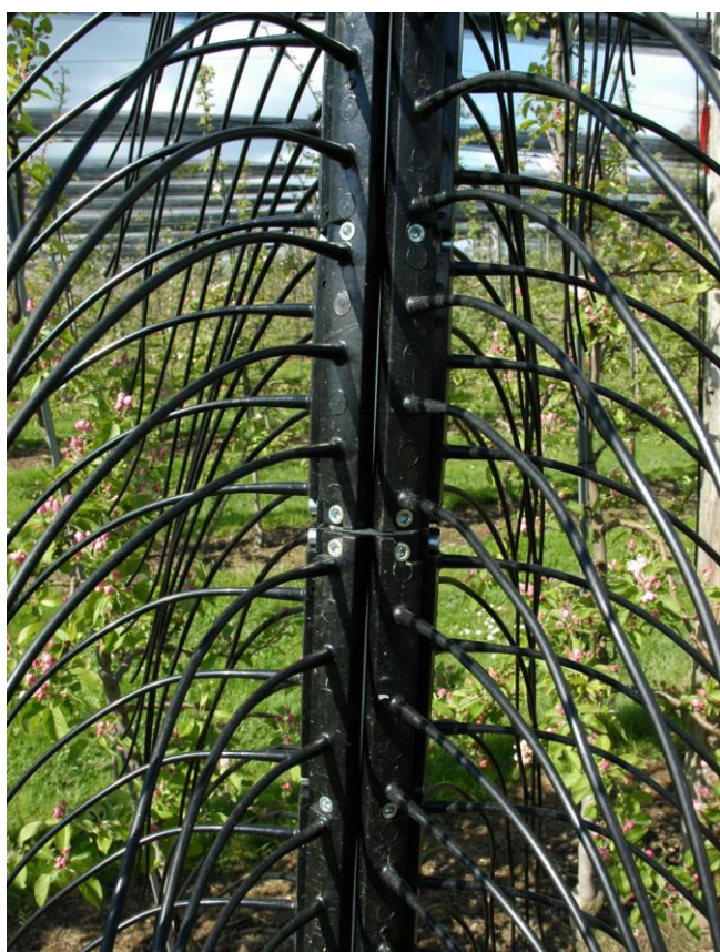
Abb. 2: Das „Tree-Darwin“-Gerät ist seit 2009 mit neuen Spritzgussfäden ausgerüstet, die eine bessere und schonendere Ausdünnung bis ins Kroneninnere ermöglichen und eine längere Haltbarkeit aufweisen. Für eine optimale Wirkung werden häufig Schnurleisten mit halber Fadenzahl eingesetzt.
