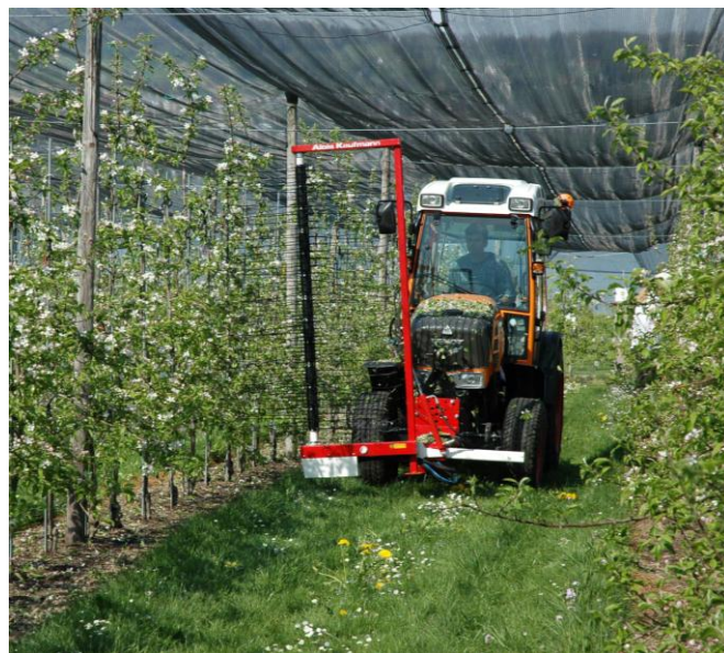
Fig. 1: L'éclaircisseuse «Tree-Darwin». Le moment d'utilisation, la vitesse de marche, la vitesse de l'axe et le nombre de fils déterminent le résultat de l'éclaircissage.
