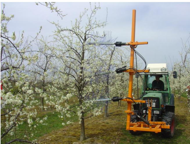
Fig. 4: L'éclaircisseuse «Typ Bonn» avec trois ou quatre axes horizontaux réglables convient aux arbres de forme plus grande et donc aussi aux fruits à noyau. (Photo: DLR Rheinpfalz)
