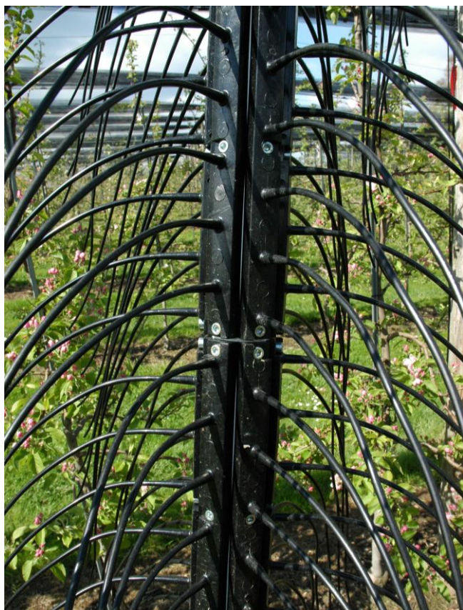
Fig. 2: La machine «Tree-Darwin» est équipée depuis 2009 de nouveaux fils moulés par injection qui permettent un meilleur éclaircissage plus respectueux jusqu'au cœur de l'arbre et qui ont de surcroît une plus grande résistance. On utilise souvent des profilés avec seulement la moitié des fils pour obtenir une efficacité optimale.
