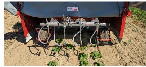
Abbildung 1: Die Banddüsen werden über den Pflanzenreihen geführt. Die Düsen öffnen sich kurz vor und kurz nach jeder Kulturpflanze. So können die Kulturpflanzen gezielt behandelt werden (Foto: Agroscope).
