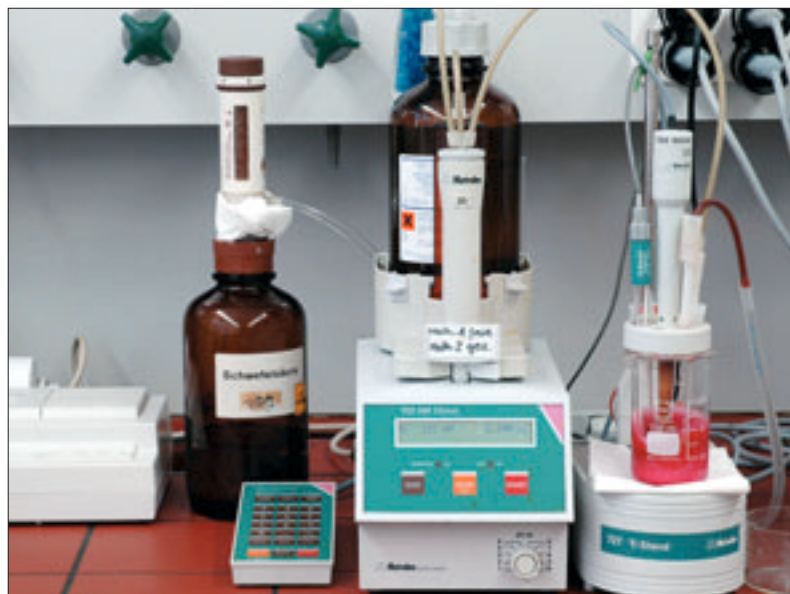
Abb. 2: Titrationsautomat zur Messung der freien und der gesamten schwefligen Säure.
