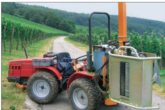
Abb. 2: Binger-Entlauber EB 490, hier an einem Schlepper mit Rückfahreinrichtung.
