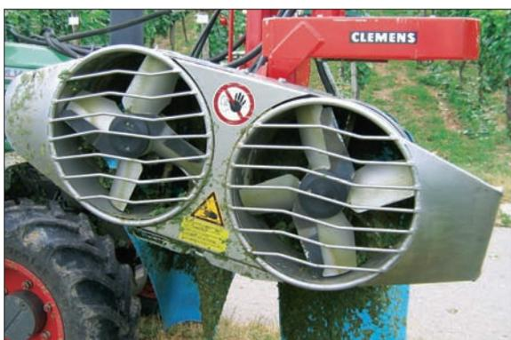
Abb. 3: Clemens Entlauber zur Anpassung der Arbeitsbreite leicht geschwenkt.
