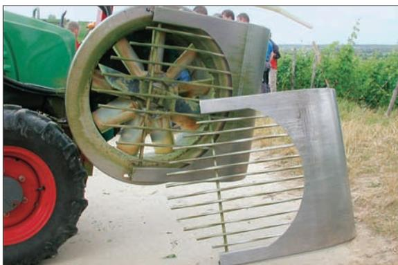
Abb. 4: Der Entlauber von Ero ist mit verschiedenen Gleitblechen erhältlich.
