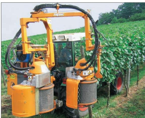
Abb. 5: Entlauber von Pellenc sind seit 2005 auch als Schlepper-Anbauvarianten erhältlich.
