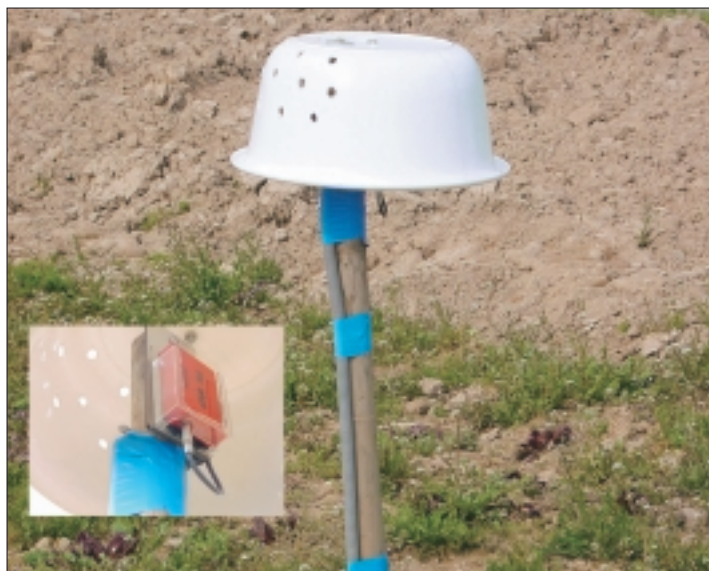
Fig. 2. L'enregistreur de données de type HotDog (ELPRO-BUCHS AG) avec capteur de température interne pour la température de l'air et un palpeur pour mesurer la température du sol. Le chapeau blanc sert de protection contre le rayonnement direct et le tuyau gris protège le câble du capteur de température du sol contre les souris. (Photo: FAW)
