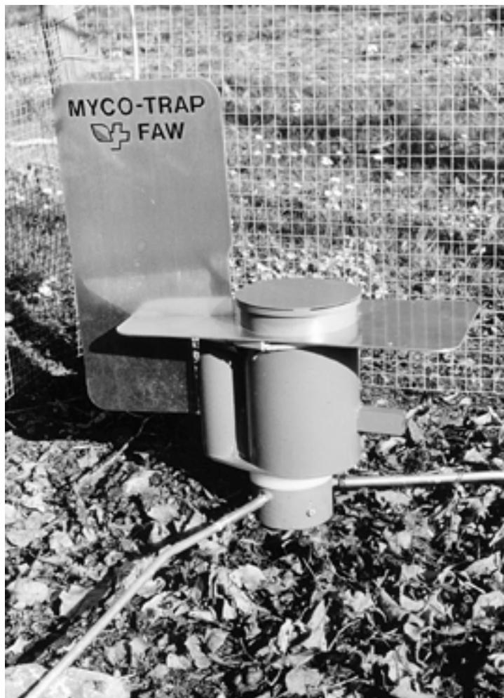
Abb. 4. An der FAW entwickelte Falle (Myco-trap) zur Quantifizierung des Sporenfluges wichtiger Apfel- und Rebenkrankheiten.
