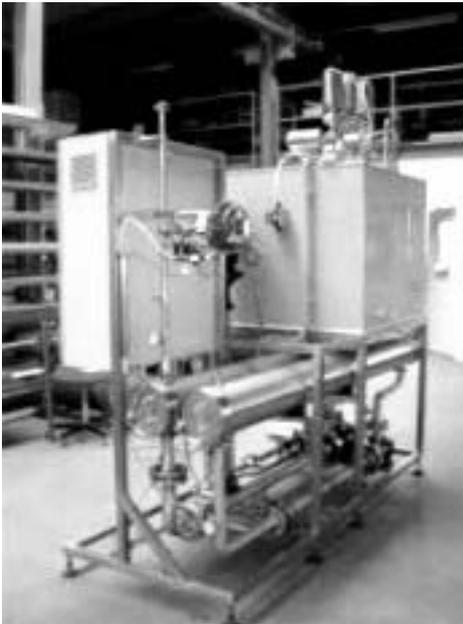
Photo: exemple d'installation d'osmose inverse
