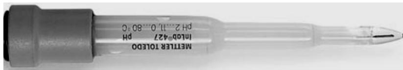
Glaselektrode mit Gelelektrolyt
