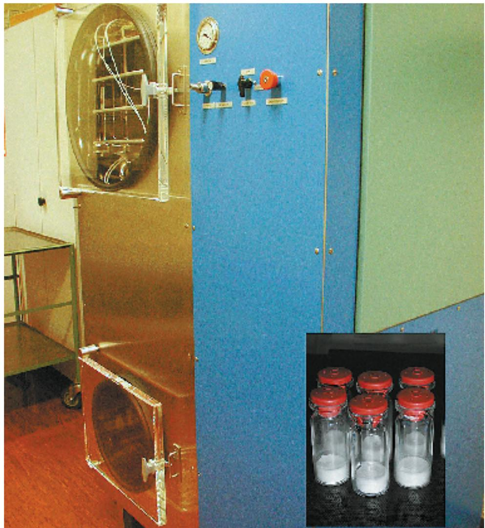
In dieser Anlage werden Milchsäurebakterien gefriergetrocknet (Minilyo, Usifroid). (Bild: ALP)
