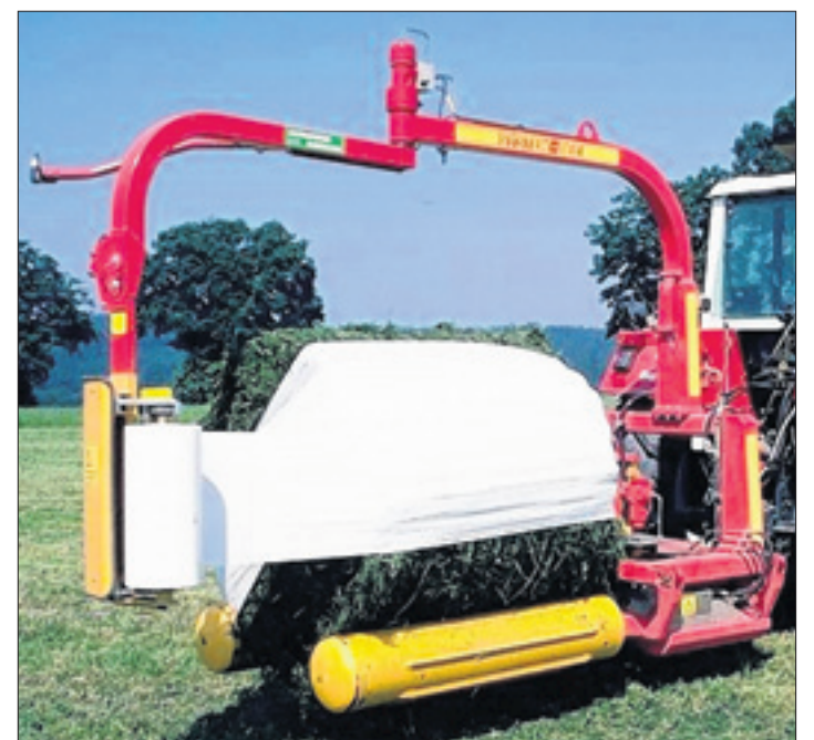
Ein fachgerechtes Wickeln der Siloballen ist entscheidend, damit keine Luft in die Ballen eindringt und keine Probleme auftreten.
