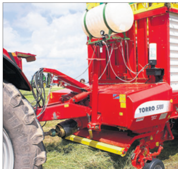
Mit einem geeigneten Dosiergerät können die Siliermittel homogen verteilt werden.
