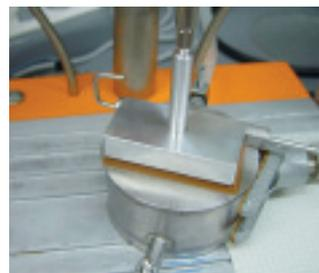
**Abbildung 6: Einrichtung für die Durchführung des Abschmelztests (Foto: ALP)**
