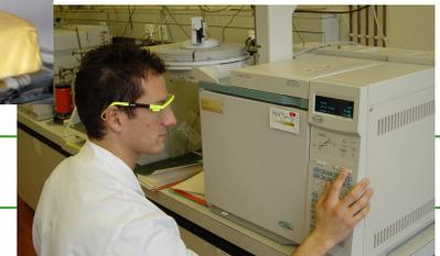
Bestimmung des TFS-Gehalts mittels Gaschromatografie
