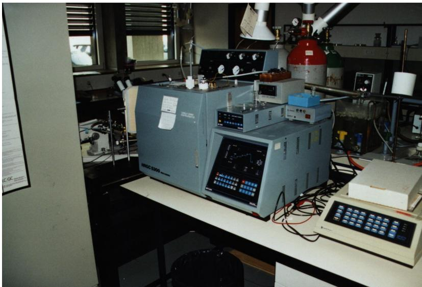
Abb. 2 Mit der Elektrophysiologiestation gekoppelter Gaschromatograph.
