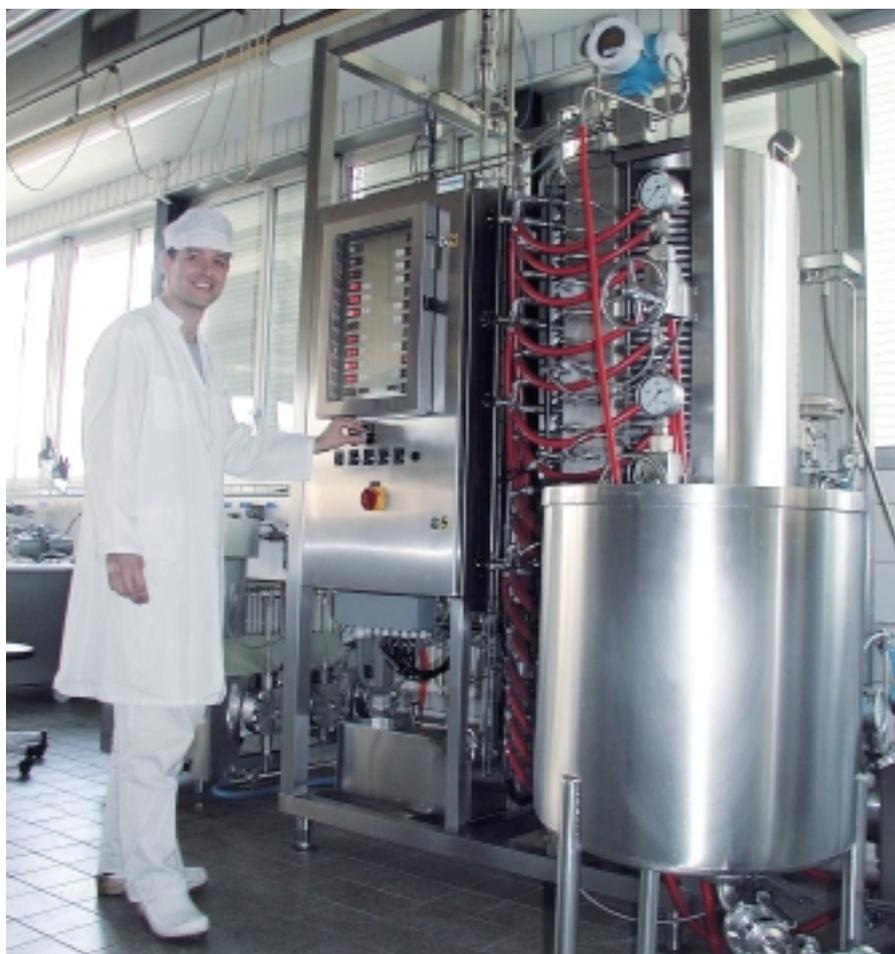
Fig. 1. Traitement thermique avec l'installation-pilote développée par Agroscope Liebefeld-Posieux (ALP) (système tubulaire flexible; débit 100 l/h).
