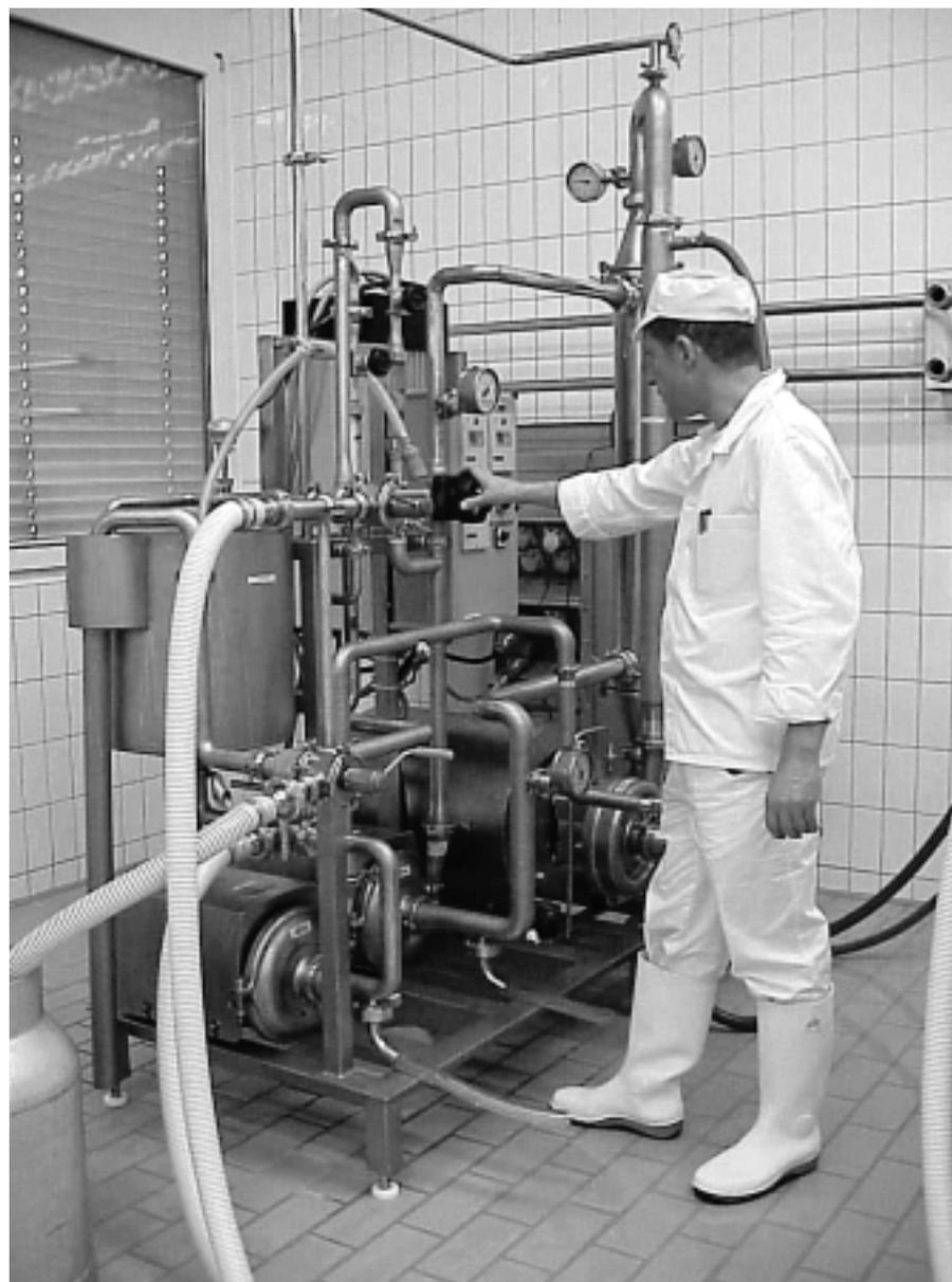
Fig. 2. Petite installation fabriquée par Tetra Pak avec des éléments céramiques pour des essais d'ALP.
