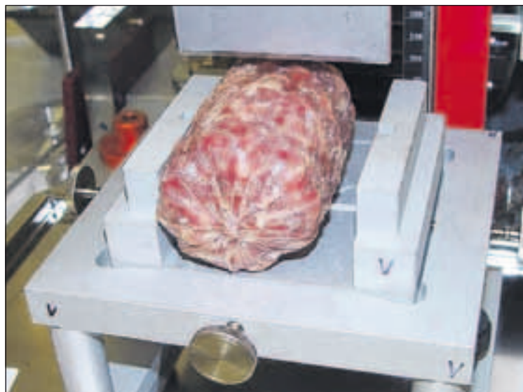
Mesure de la fermeté à la coupe des salamis.
