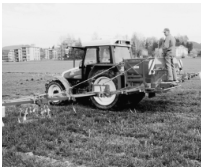
Fig. 3: Le distributeur d'engrais pneumatique (gauche) répartissait les engrais minéraux dans les parcelles d'essai et l'épandeur à tuyaux souples (droite), le lisier.
