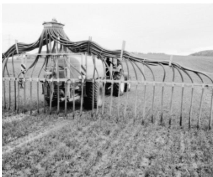
Fig. 3: Le distributeur d'engrais pneumatique (gauche) répartissait les engrais minéraux dans les parcelles d'essai et l'épandeur à tuyaux souples (droite), le lisier.
