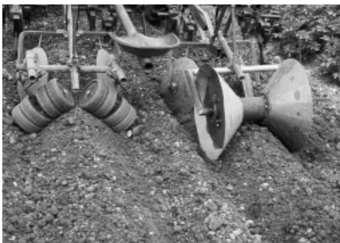
Abb. 6: Vergleichsversuche mit Mehrfach-Dammdruckrollen (links) und Einzelprofilwalze (rechts).
