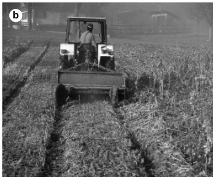
Abb. 4: Mittels Häufelkörper werden beim Bearbeiten und Begrünen Fahrspuren angelegt (a). Bei den nachfolgenden Arbeitsgängen – Beispiele: Schlegeln (b) und Mulchlegen (c) – muss der für den Dammaufbau benötigte Boden nicht mehr befahren werden.
