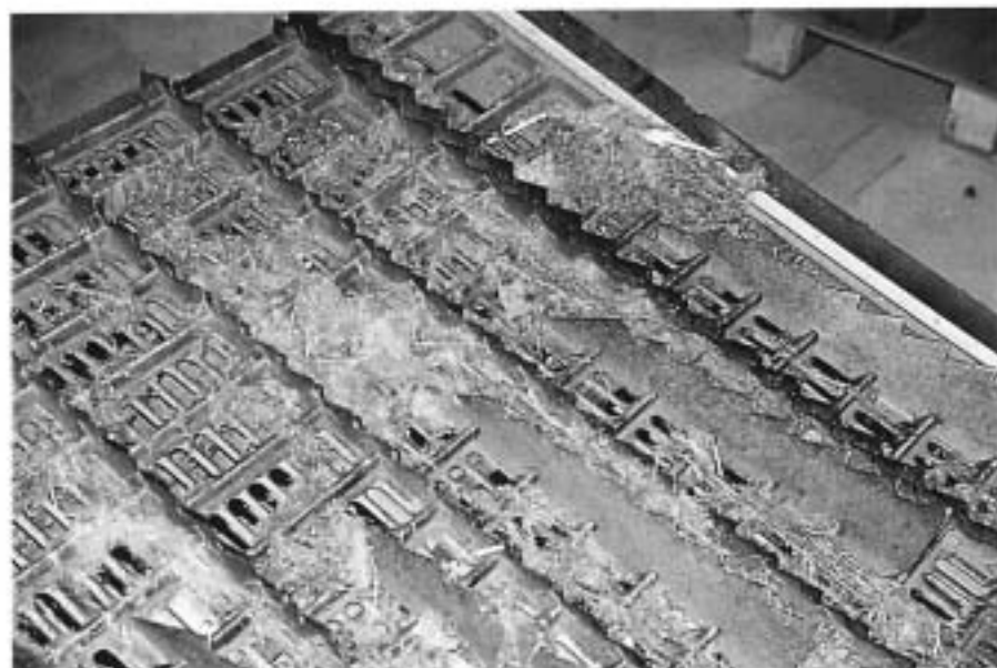
Fig. 17. Les points critiques de la moissonneuse-batteuse (par exemple, surface du secoueur) doivent constamment être vérifiés et éventuellement nettoyés.
