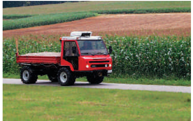
Abb. 4: Versuchsfahrten – hier mit \frac{2}{3} -Nutzlast – mit 30, 35 und 40 km/h auf einer asphaltierten Nebenstrasse mit Ausbesserungsstellen im Belag.
