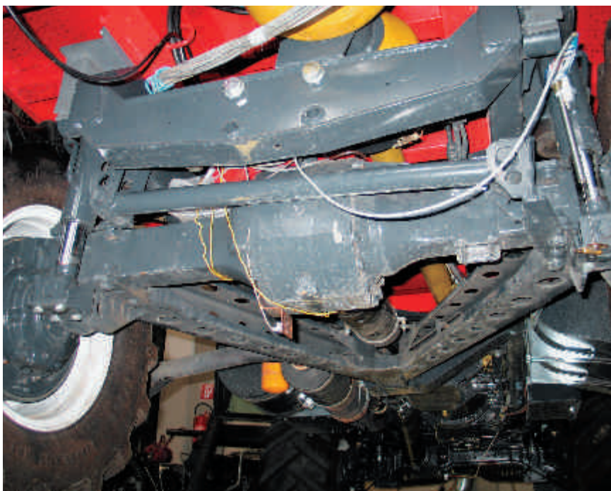
Abb. 10: Beim Schiltrac 2068SF sind die Starrachsen durch einen langen Dreieckrahmen geführt und vor den Achsen gelenkig am Fahrzeugrahmen abgestützt. Die beiden Federungszyylinder bilden nahe der Räder die Verbindung zwischen Achse und Rahmen. Gut sichtbar der kräftige Querstabilisator zur Aufnahme der Seitenkräfte.
