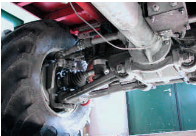
Abb. 7: Gut sichtbar ist der untere Dreieckquerlenker dieser Doppel-Querlenker-Aufhängung beim Aebi TP 88. Dahinter ist der rote Federzylinder zu sehen.
