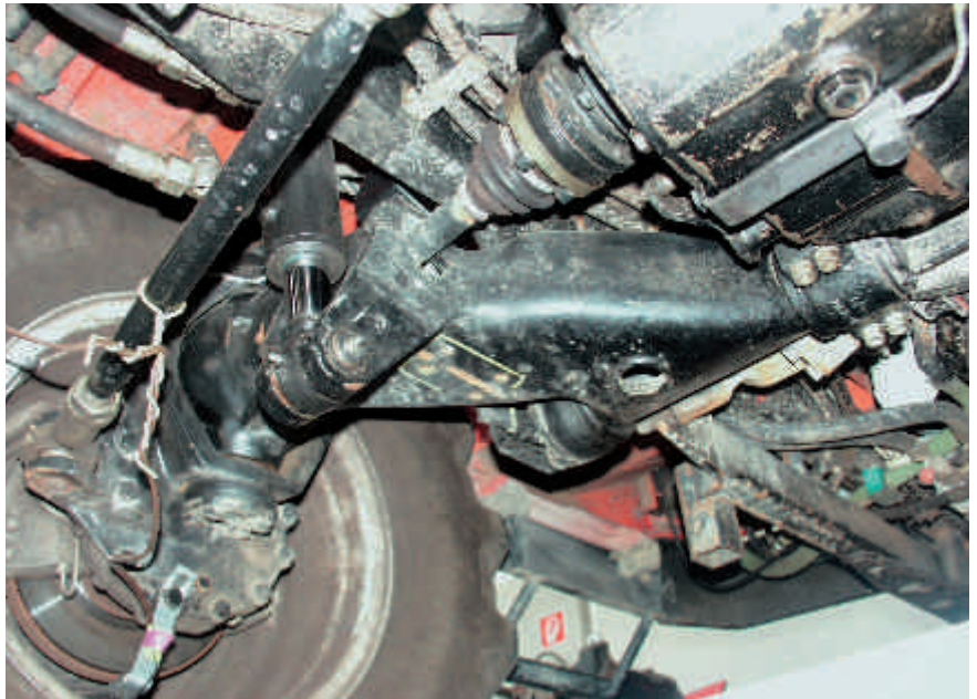
Abb. 9: Die Radaufhängung beim Reform T9 ist durch einen breiten Längslenker gekennzeichnet, der beim Rad mit dem Federungszyylinder gegen den Fahrzeugrahmen abgestützt ist. Durch die Portalachs-Konstruktion gewinnt man grössere Bodenfreiheit.
