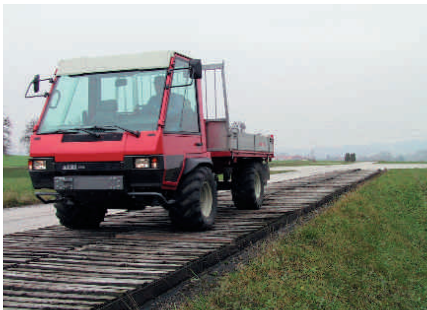
Abb. 2: Versuchsfahrten mit Geschwindigkeiten von 10 bis 30 km/h auf der normierten 100-m-Holperbahn, die eine Feldweg-Charakteristik aufweist.
