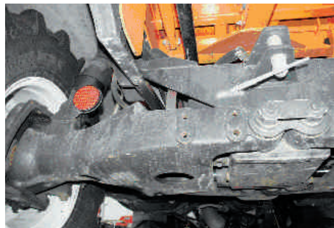
Abb. 8: Die Pendelachse des Lindner Unitrac 95 ist in massiver Konstruktion als Einfach-Dreieck-Querlenker ausgebildet.
