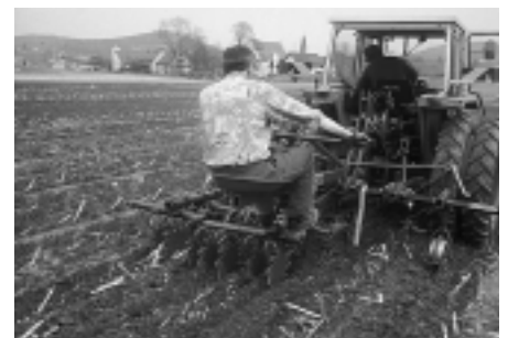
Abb. 11: Hackgeräte entwurzeln und zerschneiden Unkräuter effektiv. Sternhackgeräte verstopfen nicht...
