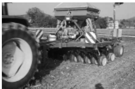
Abb. 4: Die Direktsaat mit Scheibenscharen besitzt den grossen Vorteil, dass die Schare nicht verstopfen. Der grosse Druck auf der Scheibe kann aber zu Verdichtungen im Bereich des Saatschlitzes führen, was das Auflaufen negativ beeinflussen kann.
