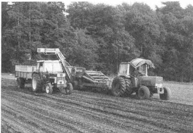
Fig. 2: Arracheuse-chargeuse à pommes de terre transformée pour le ramassage des pierres. On doit passer sur la terre travaillée et fine pour évacuer les pierres, mettant ainsi fortement le sol à contribution.
