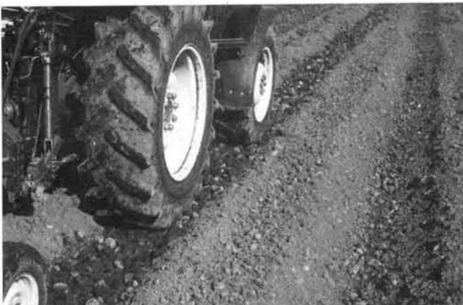
Fig. 7: Lors de l'enfouissement préalable, le tracteur avec le séparateur de sol roule déjà sur les traces de pierres séparées. Après la plantation, les corps étrangers ne sont plus visibles. Malgré cela, la portance est améliorée pour tous les travaux alors que le sol et les buttes sont ménagés.
