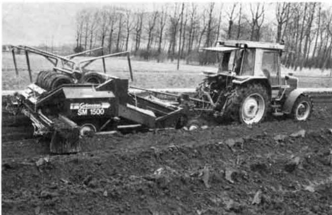
Fig. 21: Les «rouleaux aplatisseurs de mottes» (FAT) – constitués de pneus usagés à basse section – peuvent considérablement améliorer la performance du séparateur, surtout dans des sols très lourds. L'effet du travail peut être modifié en réglant la pression d'air et la force d'appui des ressorts.
