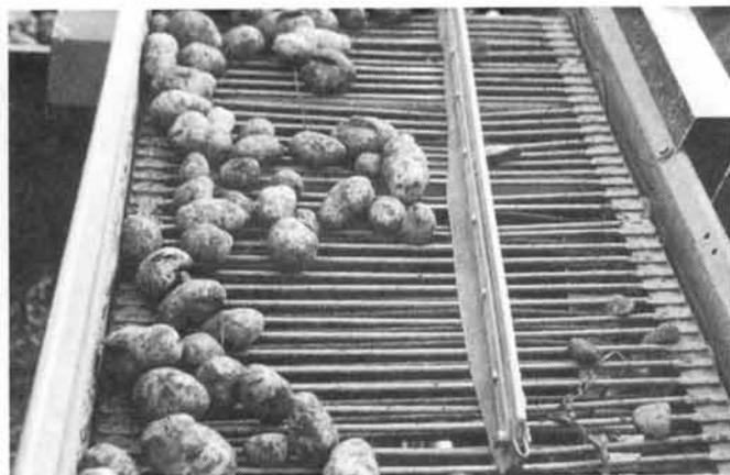
Fig. 18: La séparation du sol a permis de réduire considérablement le besoin en travail sur la récolteuse.
