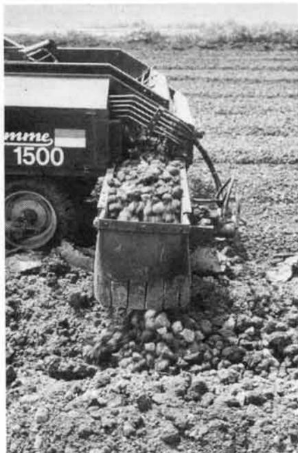
Fig. 13: Dans les sols à mottes dures, resp. cohérents, la limite de rendement est déjà atteinte à basse vitesse. Si l'on trie de trop grandes quantités de mottes, il n'y a plus assez de sol pour la formation des buttes.
