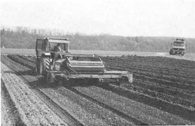
Fig. 12: Le séparateur laisse derrière lui des planches avec un sol très aéré et ameubli. Le degré de travail dépend avant tout de la largeur des trous du tamis.
