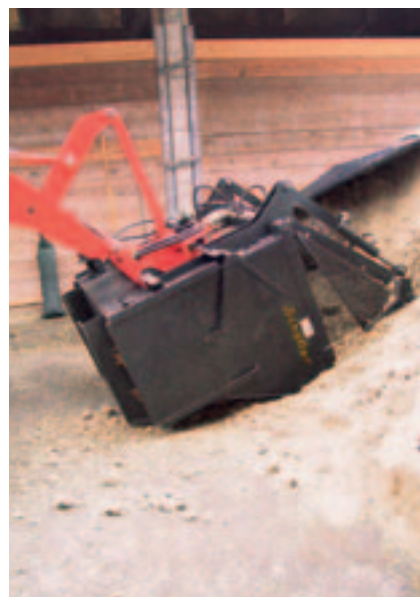
Fig. 4: Reprise de l'ensilage de cossettes de betteraves sucrières dans le silo-boudin à l'aide de la désileuse de la pelle distributrice montée au chargeur automoteur.
