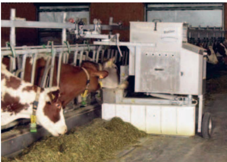
Fig. 1: Le pousse-fourrage Butler se déplace automatiquement le long de la table d'affouragement et replace le fourrage à la portée des vaches.
