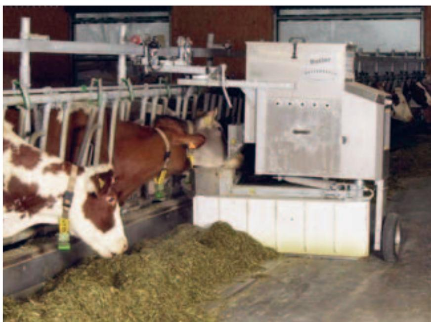
Abb. 1: Der Futternachschieber Butler fährt automatisch den ganzen Futtertisch ab und bringt das Futter wieder in Reichweite der Kühe.
