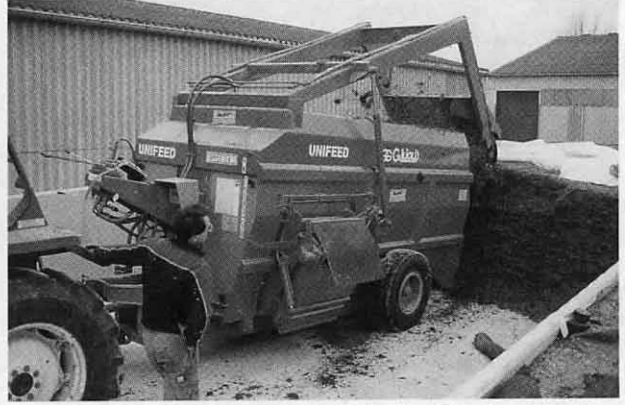
Abb. 3. Futtermischwagen am Fahrsilo. Für das Abfräsen des Futters wird der hintere Teil des Mischwagenbehälters ganz auf den Boden abgesenkt. Für das Wiegen muss der angehobene Behälter waagrecht liegen. Beim Traktor ist deshalb eine korrekte Anhänghöhe wichtig.
