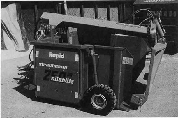
Abb. 2. Das ETV-Gerät, hier an der Ackerschleife anzuheben, erlaubt ein übersichtliches Arbeiten und eignet sich auch für kleine Futtertennen. Jedoch kann gegenüber dem Blockschneider nur wenig Arbeitszeit eingespart werden.
