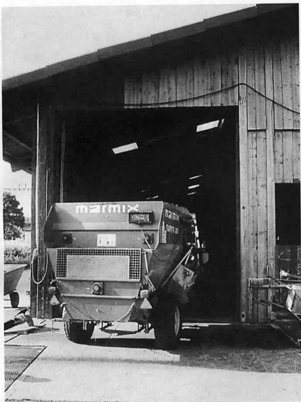
Abb. 7. Futtermischwagen in Futterterreneinfahrt. Bei der Wahl des Futtermischwagens ist auf die Masse von Einfahrten (Torhöhe und -breite) und Zufahrten zu achten. Futtermischwagen müssen gemäss den Vorschriften des Strassenverkehrs und der Unfallverhütung ausgerüstet sein.
