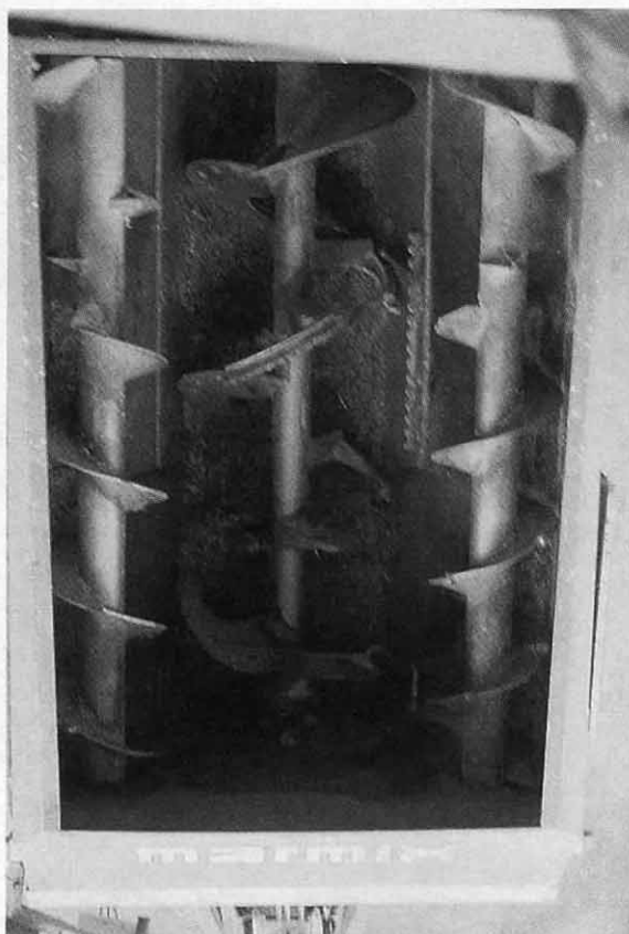
Abb. 6. Mischschnecken eines Dreischneckenmischers. Dreischneckenmischer (hier mit Rührwelle) mischen schonend und schnell, eignen sich jedoch nicht für den Einsatz von Rund- und Quaderballen. Futterresten unten im Behälter müssen bei allen mobilen Fütterungseinrichtungen regelmässig entfernt werden.
