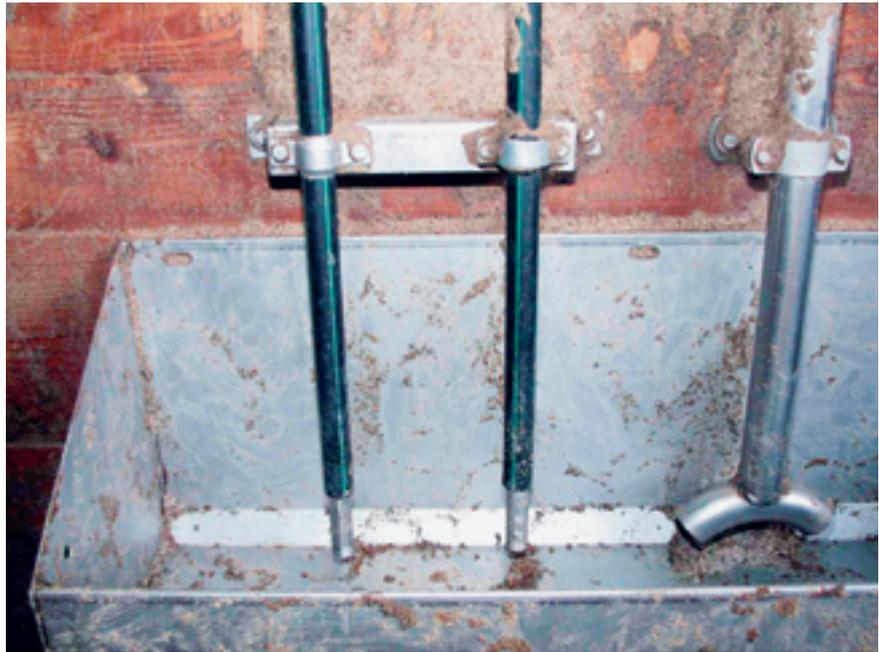
Abb. 2: Bevor erneut Futter ausdosiert werden kann, wird durch einen Sensor geprüft, ob der Trog leer ist.
