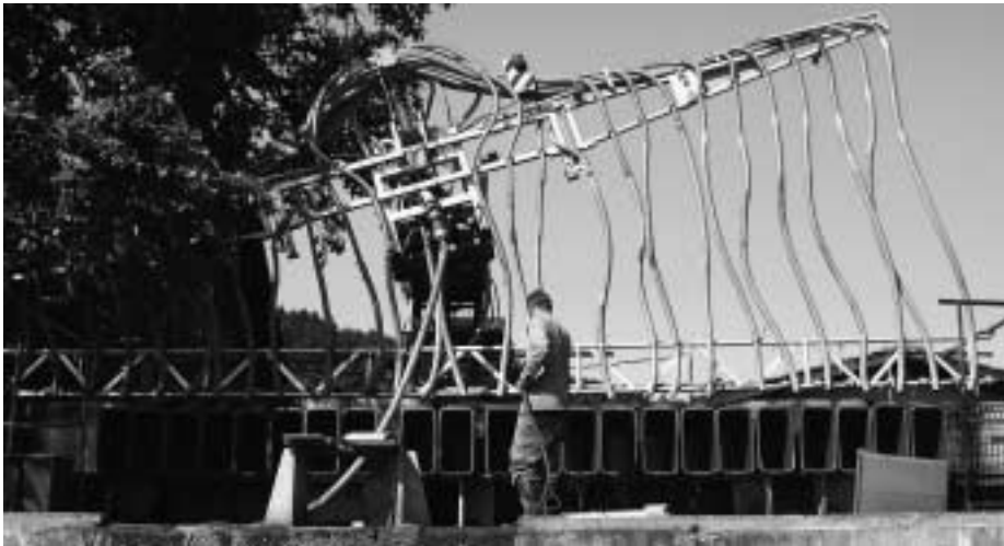
Fig. 8: Des récipients de 60 l recueillent le lisier qui s'écoule des différents tuyaux. La photo représente la simulation d'un épandage sur un terrain dont la pente est de 30% avec des tuyaux rallongés en conséquence. Les mesures ont été répétées trois fois pour chaque réglage.
