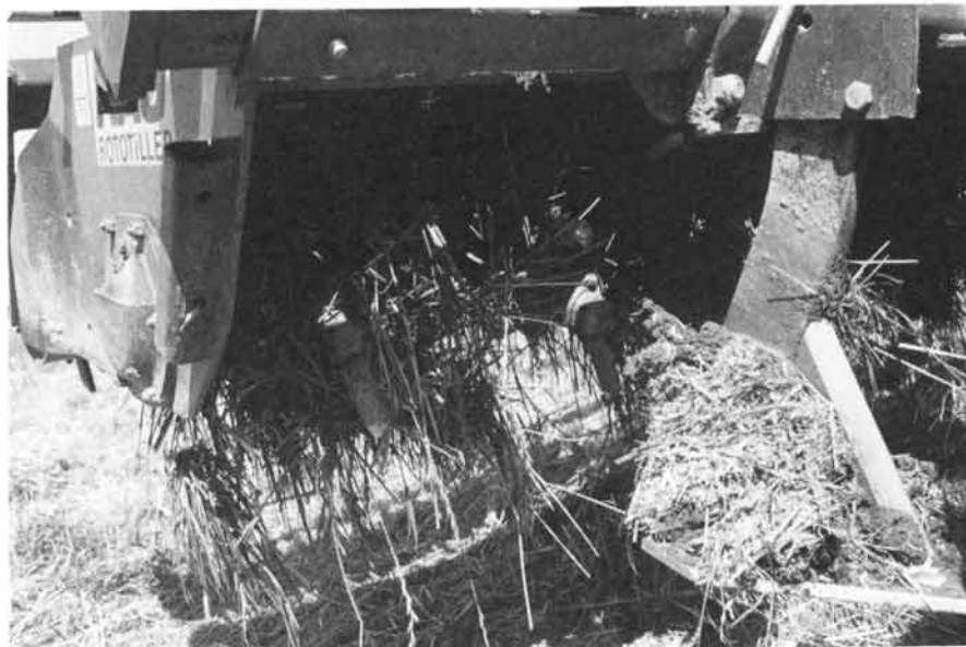
Fig. 19: La rangée de dents avant de la herse rotative à axe horizontal (Rau) réduit l'usure des dents du rotor et permet de maintenir une profondeur de travail constante même à des vitesses d'avancement relativement élevées. En présence de paille hachée, elle risque cependant de se boucher.
