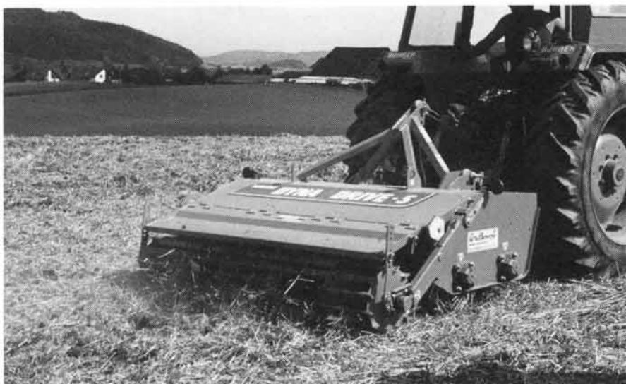
Fig. 16: Travail superficiel et intensif du double rotor à dents (Dyna).
