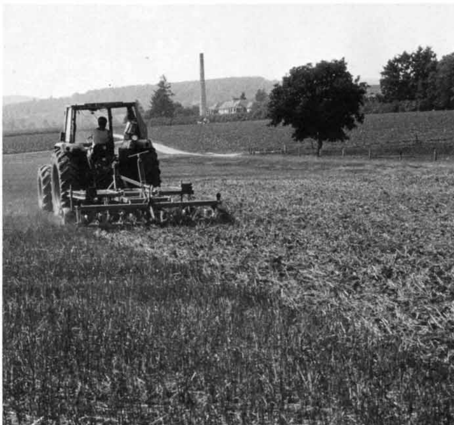
Fig. 1: Le but du déchaumage consiste à enfouir la paille, à lutter contre les adventices, à stimuler la germination des graines non récoltées et à préparer le sol pour la culture suivante. Il est très important que la paille à enfouir soit coupée court et épandue régulièrement.
