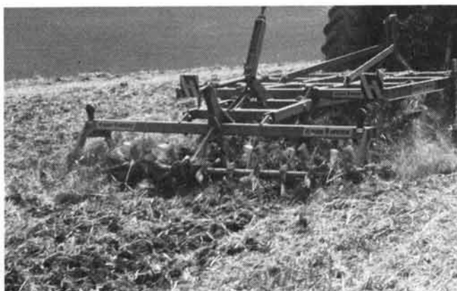
Fig. 4: Les outils suiveurs émiettent et égalisent le sol. Le peigne avec rouleau à lattes (RabR, à droite) le raffermi en plus, contrairement aux bèches roulantes (RabB, à gauche).
