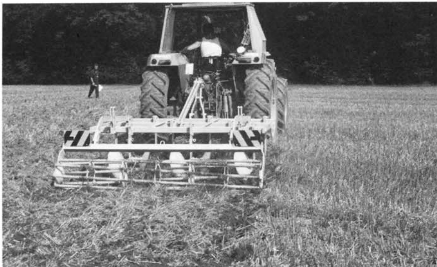
Fig. 9: Cultivateur à disques (Lemk). Lors d'un travail superficiel, le sol est travaillé sur toute la surface, ce qui favorise la lutte contre les adventices. La combinaison de dents et de disques a pour effet de bien mélanger le sol jusqu'à environ 15 cm de profondeur.
