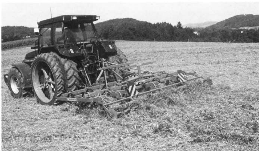
Fig. 10: Pour le transport, le vibroculteur (Koec) est replié verticalement. Le manœuvrement ne pose pas de problèmes.
