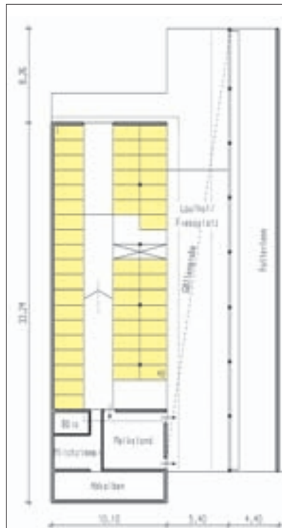
Abb. 12: Konzept eines Mehrgebäudestalles mit Liegehalle, Fressplatzüberdachung und integriertem Auslauf.
