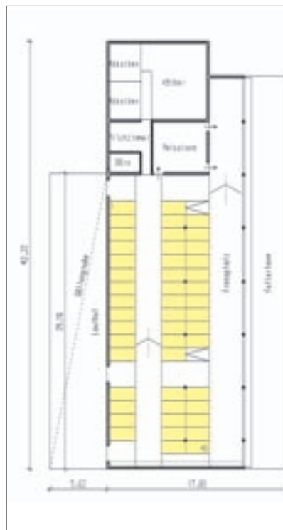
Abb. 13: Konzept eines Eingebäudestalles mit angebautem Auslauf.
