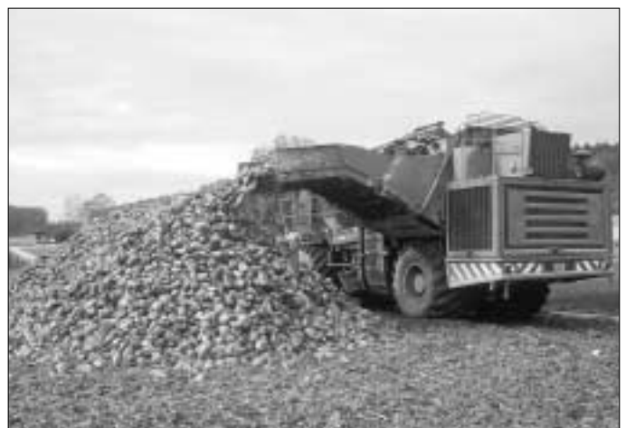
Abb. 6: Abbunkern nach jeder Runde erfordert für eine 2 ha-Parzelle nur zirka 7 min mehr als bei optimaler Bunkerauslastung.
