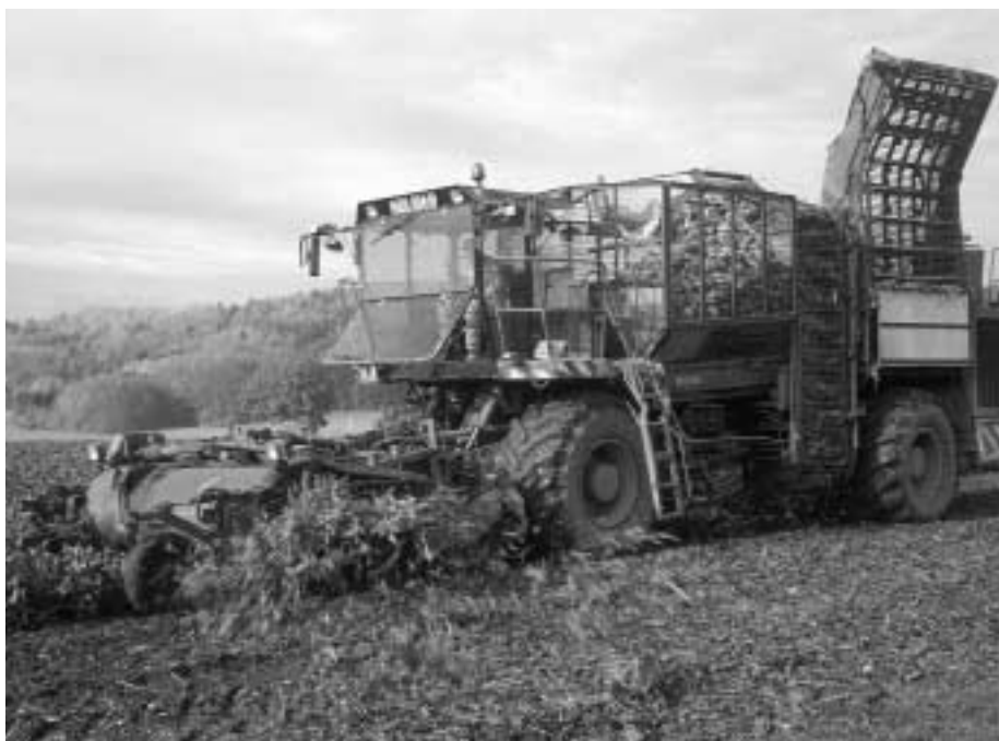
Abb. 1: Erntemaschinen mit 30–60 t Gesamtgewicht sollten nicht auf nassen Rübenböden eingesetzt werden. Dieser Vorsatz kann leider wegen des Wetterrisikos nicht jedes Jahr konsequent eingehalten werden.
