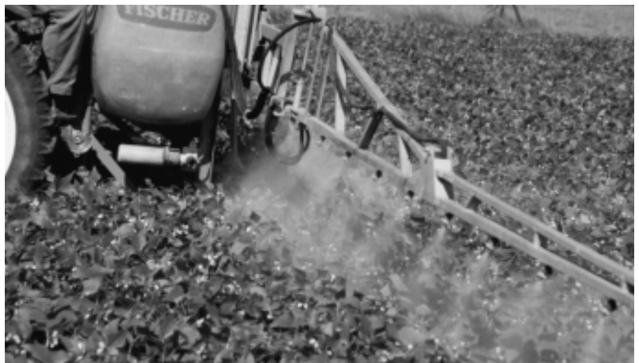
Abb. 5: Verbesserte Standardspritzung mit schräger Düsenstellung: vorne/hinten, Teejet XR/TT.
