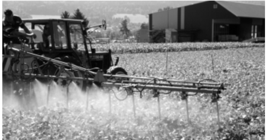
Abb. 6: Bei der Unterblattspritzung werden die Bohnen von oben schräg und von unten bespritzt. Von links nach rechts je fünf Elemente von Fischer und Benest.
