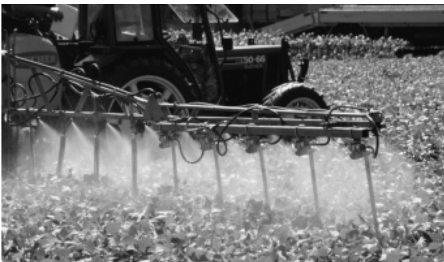
Abb. 1: Mit einer Unterblatt-Spritzeinrichtung wurden auch in dichten Buschbohnenbeständen die besten Fungizid-Anlagerungsergebnisse erzielt. Rechts: Ein Spritzelement von Benest/GB.
