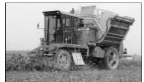
Fig. 2b: Décolleteuse-arracheuse à trémie automotrice à trois rangs (DAT AM 3). Grâce à des pneus étroits et jumelés du côté gauche de la machine, il est possible de rouler entre les lignes lors de la défriche (Barigelli).
