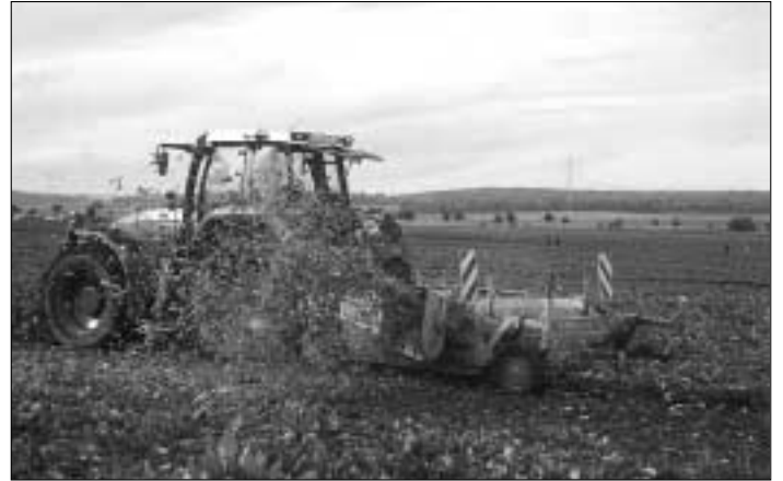
Fig. 6: Les décolleteuses-arracheuses (DA) sous forme combinées présentent un avantage: les roues ne passent pas sur les rangées de betteraves comme c'est le cas lorsque les agrégats sont séparés à l'avant et à l'arrière du tracteur (D,A). En mode DA, la défriche en sol non foulé est possible.
