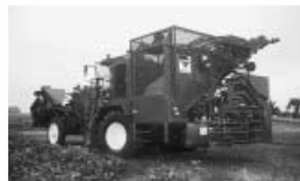
Fig. 1: Les largeurs de travail les plus élevées sont actuellement obtenues avec une décolleteuse-arracheuse-chargeuse à neuf rangs (DAC AM 9, Moreau) (a). Pour le transport sur route, il est possible de rabattre la décolleteuse à fléaux sur le côté, ainsi que le dispositif de nettoyage à turbine (b).
