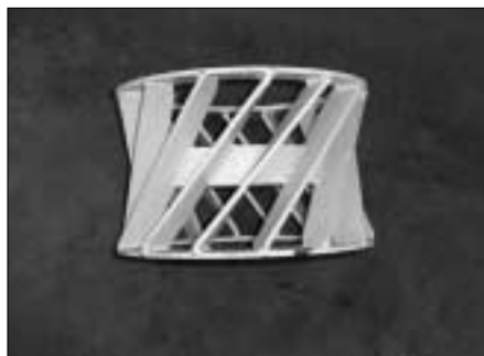
Fig. 11: Le système de décolletage post-éfeuillement à vis permet, grâce à sa surface de travail conique, de décoller également les implantations des feuilles les plus basses avec des pertes de rendement relativement faibles (Garford).
