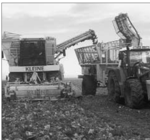
Fig. 4: Décolleteuse-arracheuse à trémie automotrice à six rangs, petit modèle (DAT AM 6, petite). Lorsque les parcelles sont courtes, les betteraves peuvent être transportées jusqu'à l'extrémité du champ. Lorsque les parcelles sont longues, la machine est utilisée comme décolleteuse-arracheuse-chargeuse avec trémie intermédiaire.
