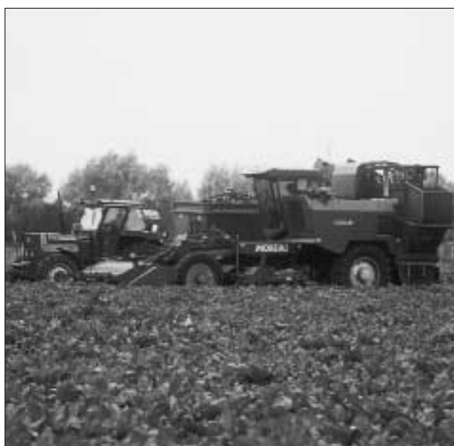
Fig. 5: Les décolleteuses-arracheuses-chargeuses auto-motrices (DAC) avec une largeur de travail pouvant aller jusqu'à 9 rangs sont surtout employées en France, où les betteraves ne sont pas déposées en meules en bords de champs, mais sur des surfaces en dur plus éloignées.
