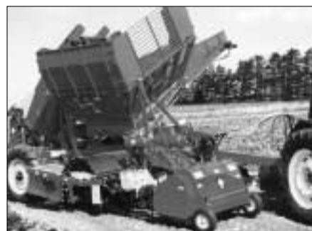
Fig. 2a: Décolleteuse-arracheuse à trémie tractée à trois rangs (DAT 3) avec décolleteuse à fléaux. Le modèle à deux rangs dispose d'un système identique (TIM).
