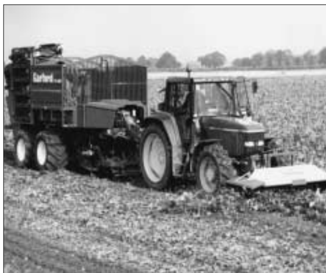
Fig. 3: Le système de décolletage-arrachage à trémie entraîné de Garford GB (D, AT 3/4/6) exige un système de voies de passage (espace inter-ligne important là où il y a passage des roues) adapté à trois, quatre ou six rangs. Seule l'effeuilleuse est montée à l'avant du tracteur. Les deux essieux de l'arracheuse-chargeuse sont à entraînement hydraulique.
