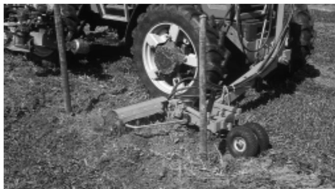
Abb. 4: Der Boden wird mit Flachschar unterschritten und mit dem Messerrotor zerkleinert (Müller). Rechts: Dritter Hackgang 1998.
