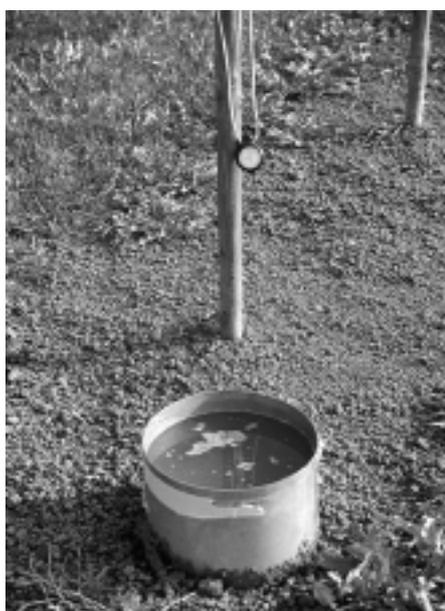
Abb. 6: Die Wasserinfiltration im Baumstreifen wurde mit einem Zylinder – Ø 28 cm, 10 l Wasser und einer Stoppuhr bestimmt.
