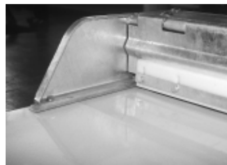
Fig. 34: Les surfaces en béton de plus en plus nombreuses et l'évacuation de plus en plus fréquente du fumier remettent l'emploi d'une couche d'usure au goût du jour pour les racleurs rabattables et combinés.
