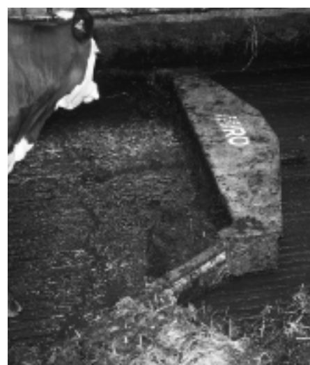
Fig. 35: Avec le robot d'évacuation, les évidements pour les dispositifs d'entraînement ne sont plus nécessaires, ni les changements de direction. C'est pourquoi ce système est d'un emploi particulièrement souple. Ses grandes dimensions impliquent des vitesses de progression très réduites, pour ne pas créer de risques de blessures supplémentaires.
