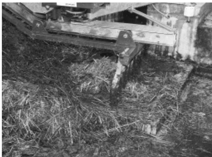
Fig. 22: La zone de transfert vers l'élevateur doit être facile d'accès. Les plates-formes surélevées par rapport à la fumière sont mieux adaptées que les cuvettes construites à grand frais.
