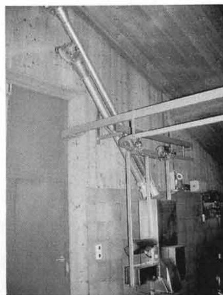
Abb. 4. Als Zusatzausrüstung sind automatische Füllstationen erhältlich. Damit werden in der Park- oder in einer Füllposition die Behälter aufgefüllt. Einfachere Lösungen stellen handbetätigte Schieber dar.
