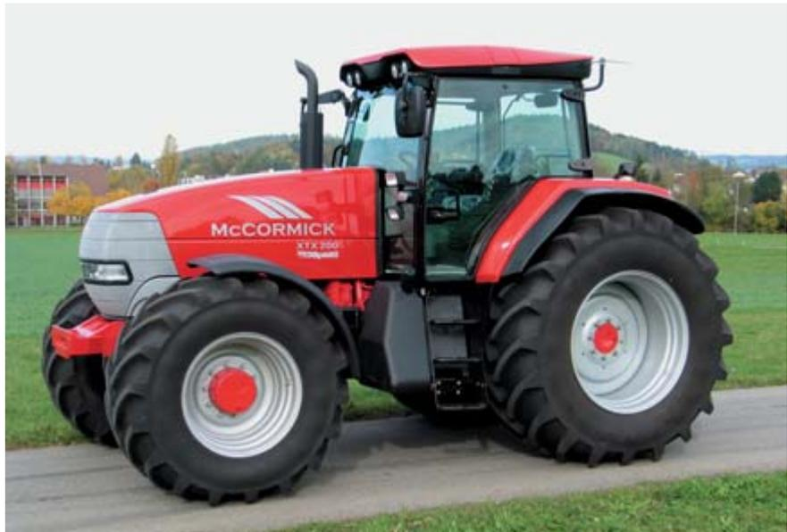
Abb. 10: Traktor Mc Cormick XTX200, 6-Zylinder-Turbomotor mit Ladeluftkühlung, 134 kW (182 PS), acht Lastschaltstufen, Vorderachs- und Kabinenfederung, Gewicht 7960 kg, Testbericht Nr. 1903/06.
