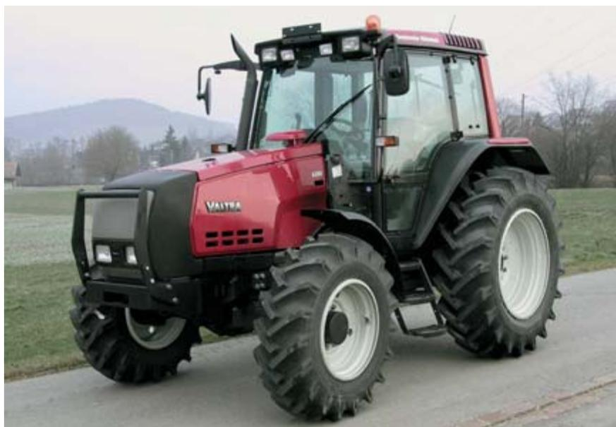
Abb. 8: Traktor Valtra 6350-4, 4-Zylinder-Turbomotor, 74kW (101 PS), drei Lastschaltstufen, Gewicht 4610kg, Testbericht Nr. 1902/06.
