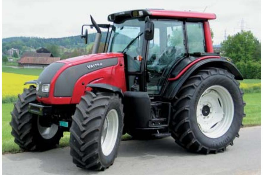
Abb. 11: Traktor Valtra N121 HiTech, 4-Zylinder-Turbomotor mit Ladeluftkühlung, 93 kW (126 PS), drei Lastschaltstufen, Vorderachsfederung, Gewicht 5460 kg, Testbericht Nr. 1909/06.
