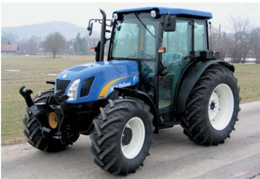
Abb. 9: Traktor New Holland TN 85DA, 4-Zylinder-Saugmotor, 60 kW (82 PS), Gewicht 3200 kg, Testbericht Nr. 1905/06.
