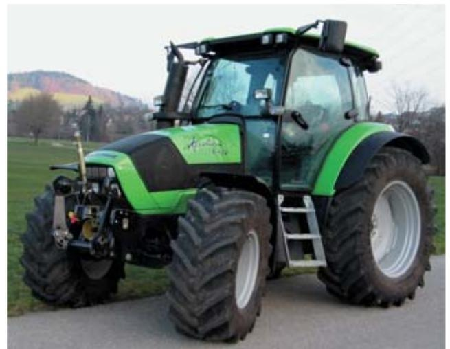
Abb. 13: Traktor Deutz Agrotron K120 Profiline, 4-Zylinder-Turbomotor mit Ladeluftkühlung, 85 kW (115 PS), drei Lastschaltstufen, Fronthydraulik und Frontzapfwelle, Vorderachs- und Kabinenfederung, Gewicht 5350 kg, Testbericht Nr. 1911/06.
