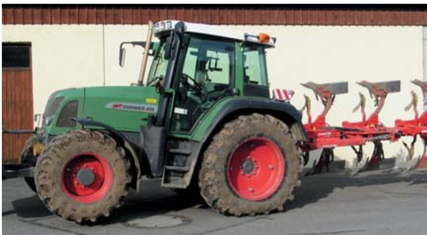
Abb. 4: Verliert die Vorderachse den Bodenkontakt, lastet das gesamte Gewicht auf der Hinterachse. Gemäss Verordnung müssen mindestens 20 % des Betriebsgewichts auf der Vorderachse liegen.
