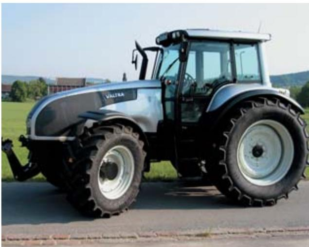
Abb. 12: Traktor Valtra T170cH, 6-Zylinder-Turbomotor mit Ladeluftkühlung, 132 kW (180 PS), drei Lastschaltstufen, Fronthydraulik, Vorderachsfederung, Gewicht 6650 kg, Testbericht Nr. 1910/06.
