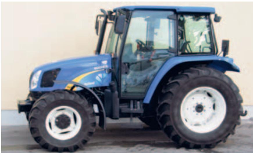
Fig. 7: Tracteur New Holland TL80A, moteur turbo 4-cylindres, 60 kW (82 CV), boîte de vitesse à passage sous charge – 2 paliers, poids 3940 kg, rapport de test n°1876/05.
