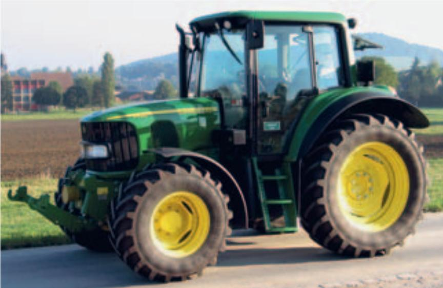
Fig. 12: Tracteur John Deere 6420 Premium, moteur turbo 4-cylindres avec refroidissement d'air de suralimentation, 81 kW (110 CV), boîte de vitesse à passage sous charge – 4 paliers, hydraulique et prise de force frontales, suspension de l'essieu avant, suspension de la cabine, frein à air comprimé, poids 5430 kg, rapport de test n°1896/05.
