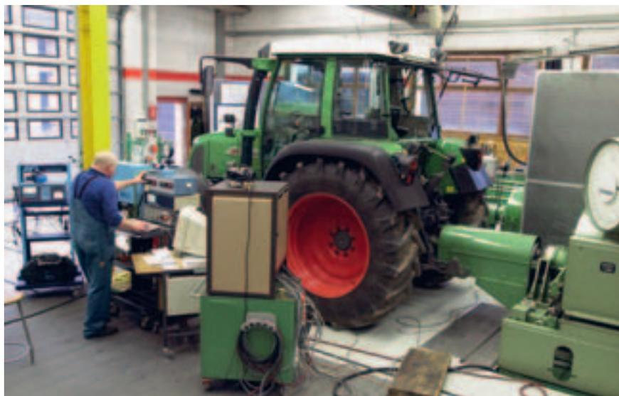
Fig. 1: Agroscope FAT Tänikon mesure la puissance à la prise de force. Cette puissance est la puissance réellement disponible pour les outils entraînés à la prise de force.
