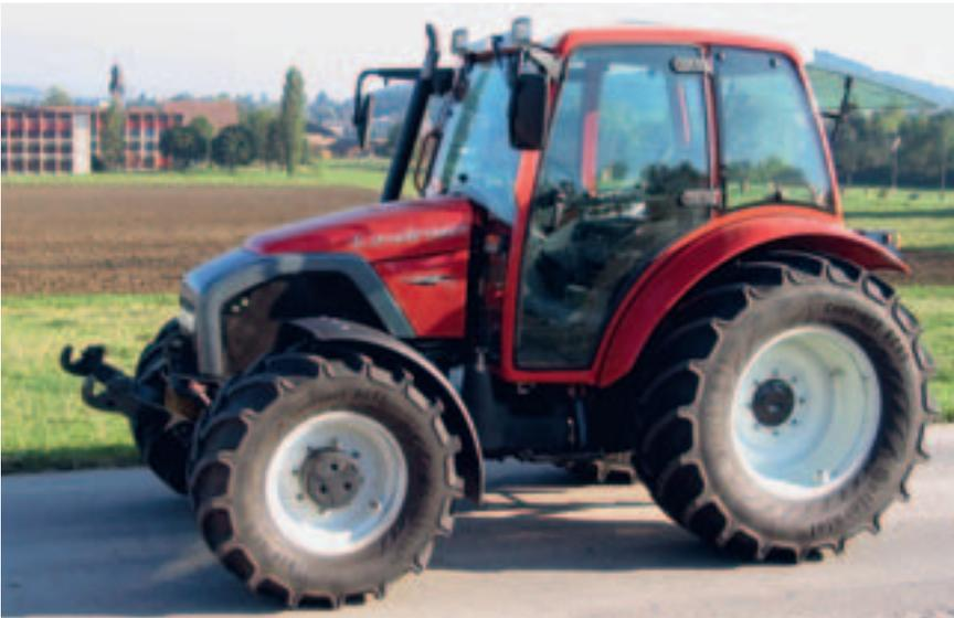
Fig. 13: Tracteur Lindner Geotrac 73 Alpin, moteur turbo 3-cylindres, 55 kW (75 CV), boîte de vitesse à passage sous charge – 2 paliers, hydraulique et prise de force frontales, poids 3530 kg, rapport de test n°1898/05.
