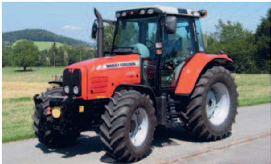
Fig. 10: Tracteur Massey Ferguson 6460 Dyna-6, moteur turbo 4-cylindres avec refroidissement d'air de suralimentation, 85 kW (115 CV), boîte de vitesse à passage sous charge – 6 paliers, hydraulique et prise de force frontales, suspension de l'essieu avant, suspension de la cabine, poids 5460 kg, rapport de test n°1894/05.
