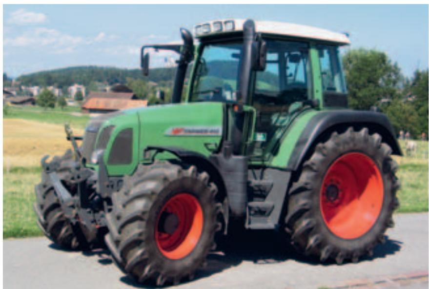
Fig. 11: Tracteur Fendt Farmer 412 Vario, moteur turbo 4-cylindres avec refroidissement d'air de suralimentation, 88 kW (120 CV), transmission à réglage continu, hydraulique frontale, suspension de l'essieu avant, frein à air comprimé, poids 5390 kg, rapport de test n°1895/05.
