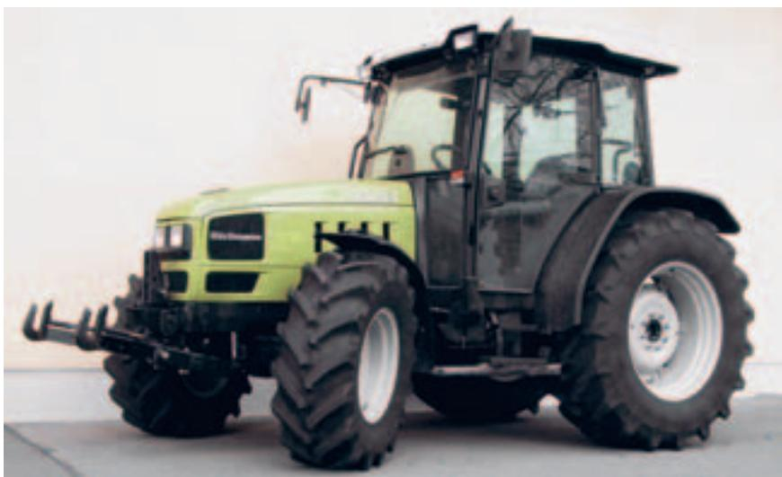
Fig. 9: Tracteur Hürlimann XA 86, moteur turbo 4-cylindres, 61 kW (83 CV), boîte de vitesse à passage sous charge – 3 paliers, hydraulique et prise de force frontales, poids 3290 kg, rapport de test n°1883/05.
