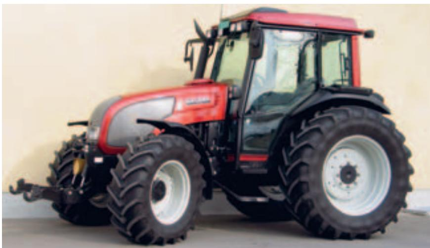
Fig. 8: Tracteur Valtra A85-4, moteur turbo 4-cylindres, 64,5 kW (88 CV), hydraulique et prise de force frontales, poids 3930 kg, rapport de test n°1880/05.
