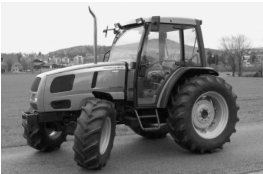
Fig. 11: Tracteur LANDINI Globus 65 Turbo, moteur turbo quatre cylindres, 55 kW (75 CV), transmission à 2 paliers de charge, poids 2920 kg (prix catalogue: Fr. 61 200.-), rapport de test n° 1811/00.
