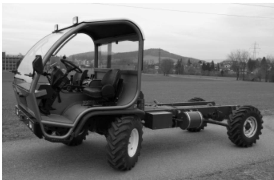
Fig. 1: Transporteur SCHILTRAC 2068 (version 40 km/h), moteur turbo quatre cylindres, 61 kW (83 CV), transmission à deux paliers de charge, poids à vide 2180 kg, poids total autorisé 7000 kg (prix catalogue Fr. 78 200.-), rapport de test transporteur FAT n° 1797/100. Les méthodes de tests techniques en Suisse et en Autriche ont été harmonisées, ce qui permet d'échanger les résultats d'un pays à l'autre.
