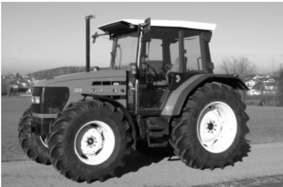
Fig. 5: Tracteur SAME Silver 100.4, moteur turbo quatre cylindres avec refroidissement d'air de suralimentation 74 kW (100 CV), transmission à 3 paliers de charge, poids 4250 kg (prix catalogue: Fr. 86 100.-), rapport de test n° 1799/00.
