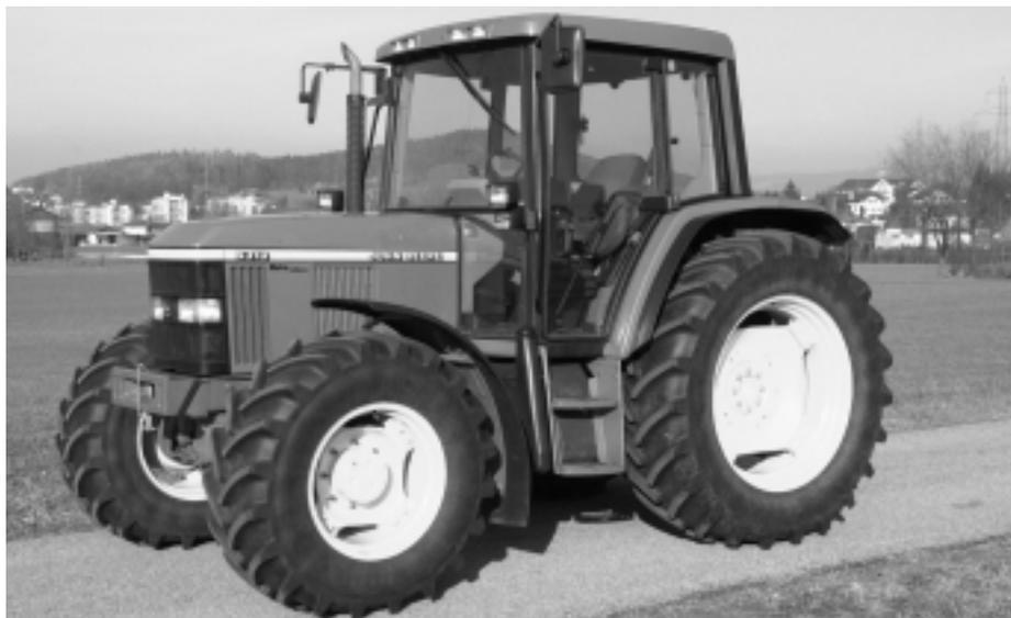
*Fig. 7: Tracteur JOHN DEERE 6310, moteur turbo quatre cylindres, 74 kW (100 CV), transmission à 4 paliers de charge, suspension avant, poids 4920 kg, (prix catalogue: Fr. 102 685.-), rapport de test n° 1801/00.*
