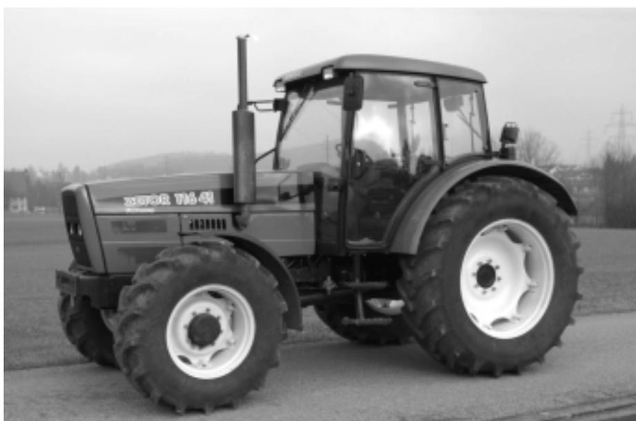
*Fig. 8: Tracteur ZETOR 116 41, moteur à aspiration, six cylindres, 81 kW (110 CV), transmission à 3 paliers de charge, poids 4610 kg, (prix catalogue: Fr. 95 138.-), rapport de test n° 1802/00.*
