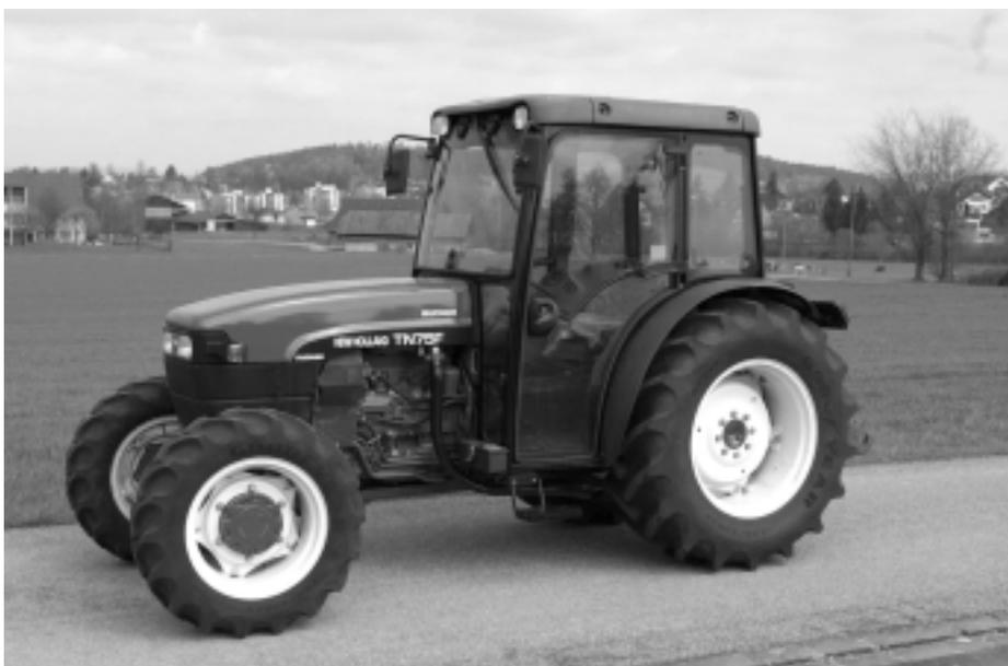
Fig. 12: Tracteur NEW HOLLAND TN 75 F, moteur à aspiration quatre cylindres, 56 kW (76 CV), transmission à 2 paliers de charge, essieu avant SuperSteer, poids 2810 kg, (prix catalogue: Fr. 71 800.-), rapport de test n° 1812/00.
