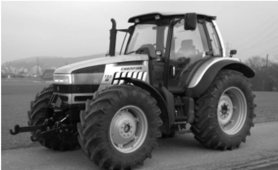
Fig. 4: Tracteur LAMBORGHINI Champion 135, moteur turbo six cylindres, trois soupapes, 99 kW (135 CV), transmission à 18 paliers de charge en deux groupes, hydraulique et prise de force frontales, poids 7200 kg (prix catalogue: Fr. 137 900.-), rapport de test n° 1798/00.
