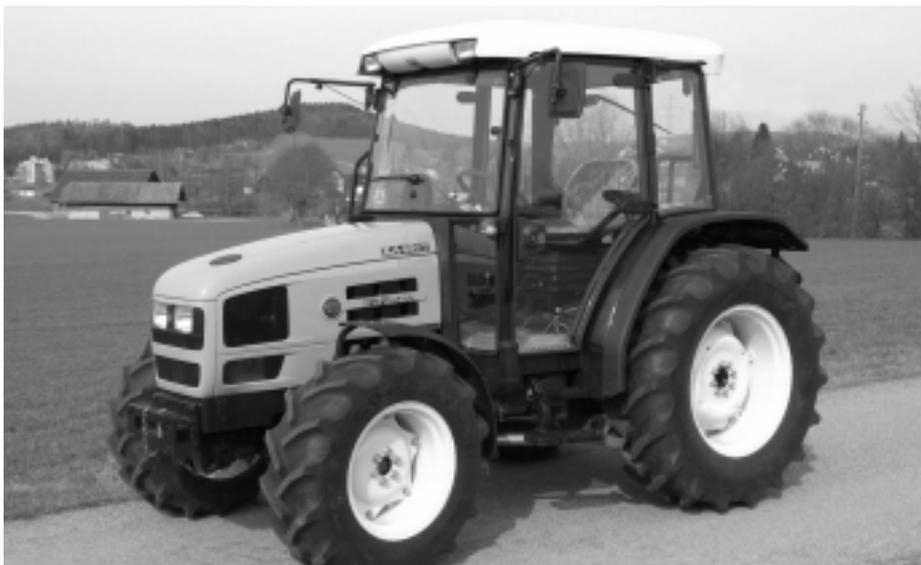
Fig. 10: Tracteur HÜRLIMANN XA 656, moteur turbo trois cylindres, 46 kW (63 CV), transmission à 3 paliers de charge, poids 2830 kg (prix catalogue: Fr. 61 200.-), rapport de test n° 1809/00.
