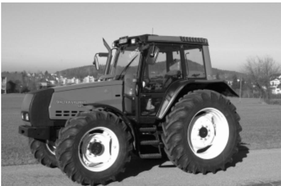
Fig. 6: Tracteur VALMET 6850-4 HiTech, moteur turbo quatre cylindres avec refroidissement d'air de suralimentation, 88 kW (120 CV), transmission à 3 paliers de charge, poids 4720 kg, (prix catalogue: Fr. 96 900.-), rapport de test n° 1800/00.
