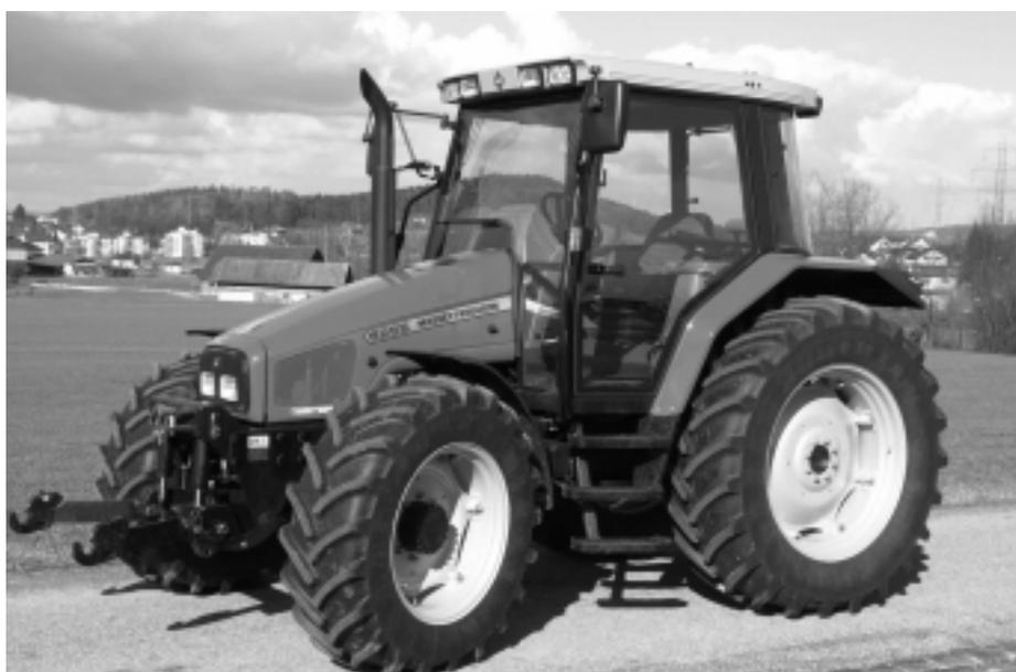
*Fig. 9: Tracteur MASSEY FERGUSON 6255, moteur turbo quatre cylindres, 70 kW (95 CV), transmission à 4 paliers de charge, hydraulique et prise de force frontales, poids 4870 kg (prix catalogue: Fr. 106 425.-), rapport de test n° 1803/00.*
