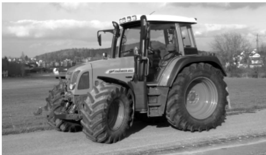
Abb. 3: Traktor FENDT Farmer 412 Vario, 4-Zylinder-Turbomotor mit Ladeluftkühlung, 88 kW (120 PS), stufenloses Fahrgetriebe, Fronthydraulik und Frontzapfwelle, Vorderachsfederung, Kabinenfederung, Gewicht 5440 kg, (Listenpreis Fr. 148 519.-), Testbericht Nr. 1850/03.
