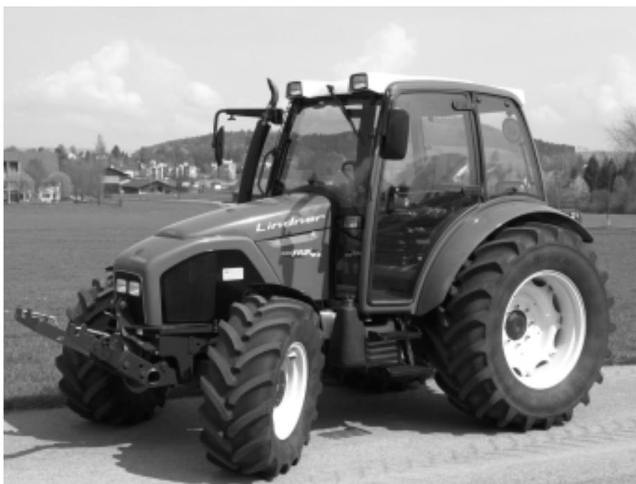
Abb. 4: Traktor LINDNER Geotrac 93, 4-Zylinder-Turbomotor mit 64.5 kW (88PS), synchronisiertes Wendegetriebe, Fronthydraulik und Frontzapfwelle, Gewicht 3670 kg, (Listenpreis Fr. 79 880.-), Testbericht Nr. 1856/03.
