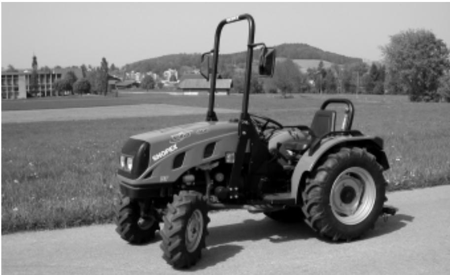
Abb. 5: Traktor BCS Vivid 400 DT, 4-Zylinder-Saugmotor mit 25.5 kW (35PS), unsynchronisiertes Wendegetriebe, Gewicht 960 kg, (Listenpreis Fr. 29 907.-), Testbericht Nr.1857/03.
