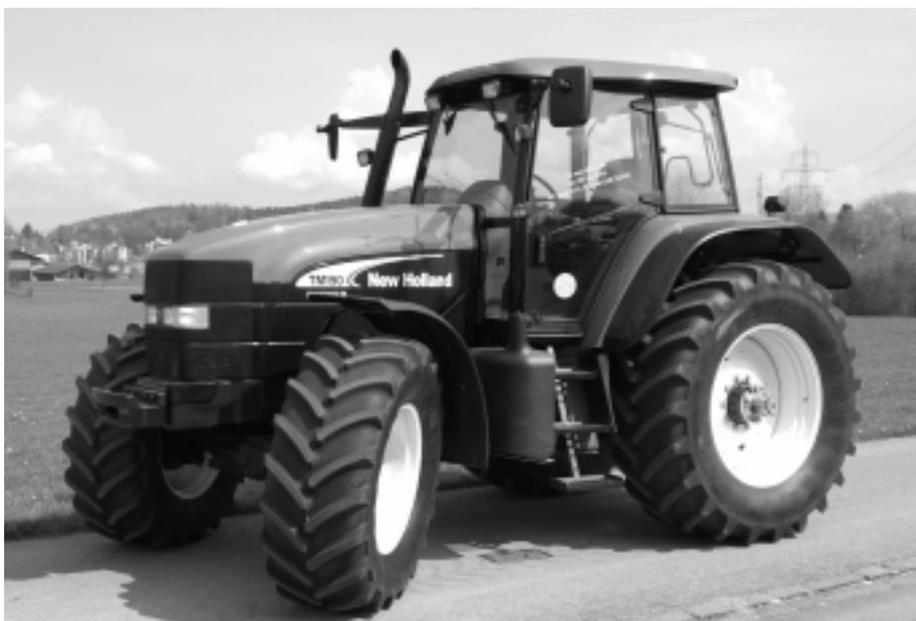
Abb. 2: Traktor NEW HOLLAND TM 190, 6-Zylinder-Turbomotor mit Ladeluftkühlung, 130 kW (177 PS) (Power Boost + 25kW), 18-Stufen-Lastschaltgetriebe, Vorderachsfederung, Kabinenfederung, Gewicht 7410 kg, (Listenpreis Fr. 151 650.-), Traktortest-Nr.1855/03
