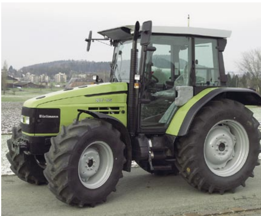
Abb. 10: Traktor HÜRLIMANN XT 95, 4-Zylinder-Turbomotor, 67 kW (91 PS), 3-Stufen-Lastschaltgetriebe, Gewicht 4120 kg, (Listenpreis Fr. 87 000.-), Testbericht Nr. 1862/04.
