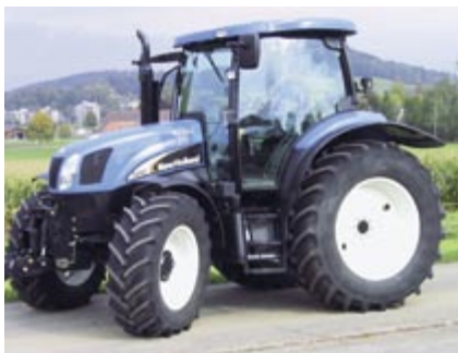
Abb. 7: Traktor NEW HOLLAND TS 110A, 4-Zylinder-Turbomotor mit Ladeluftkühlung, 85 kW (116 PS), (Power Boost + 21,7 kW), 8-Stufen-Lastschaltgetriebe, Fronthydraulik und Frontzapfwelle, Vorderachsfederung, Kabinenfederung, Gewicht 5790 kg, Sparvariante ECO-Tronic (Listenpreis Fr. 138 070.-), Traktortest-Nr. 1874/04.
