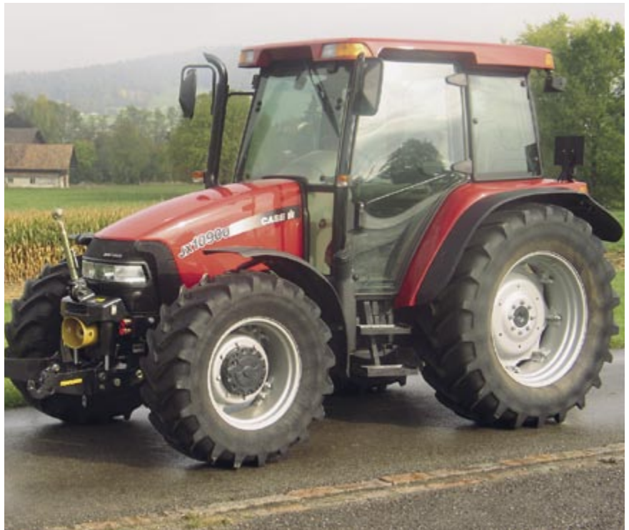
Abb. 15: Traktor Case IH JXU 1090U, 4-Zylinder-Turbomotor 65 kW (88 PS), 2-Stufen-Lastschaltgetriebe, Fronthydraulik und Frontzapfwelle, Gewicht 4370 kg, (Listenpreis Fr. 94 900.-), Traktortest-Nr. 1873/04.
