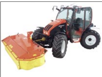
Abb. 13: Bergtraktor REFORM Mounty 80 S, 4-Zylinder-Turbomotor mit 59 kW (80PS), synchronisiertes Wendegetriebe, Fronthydraulik und Frontzapfwelle, Gewicht 2860 kg, (Listenpreis Fr. 97 798.-), Testbericht Nr. 1865/043. Auszug aus Testbericht der Bundesanstalt für Landtechnik BLT in Wieselburg (A).
