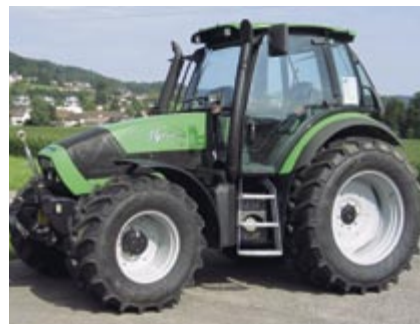
Abb. 9: Traktor DEUTZ-FAHR Agtron 118, 6-Zylinder-Turbomotor mit Ladeluftkühlung, 93,5 kW (127 PS), 4-Stufen-Lastschaltgetriebe, Fronthydraulik und Frontzapfwelle, Vorderachsfederung, Kabinenfederung, Gewicht 6250 kg, (Listenpreis Fr. 125 300.-), Traktortest-Nr. 1867/04.
