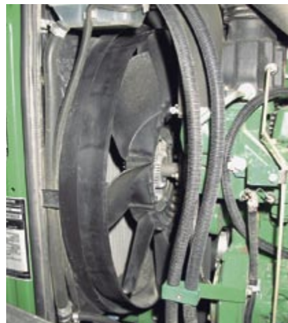
Abb. 6: Der Visco-Lüfter passt die Drehzahl und damit die Kühlluftmenge mittels geregelter Flüssigkeitskupplung automatisch dem Kühlbedarf des Motors an.
