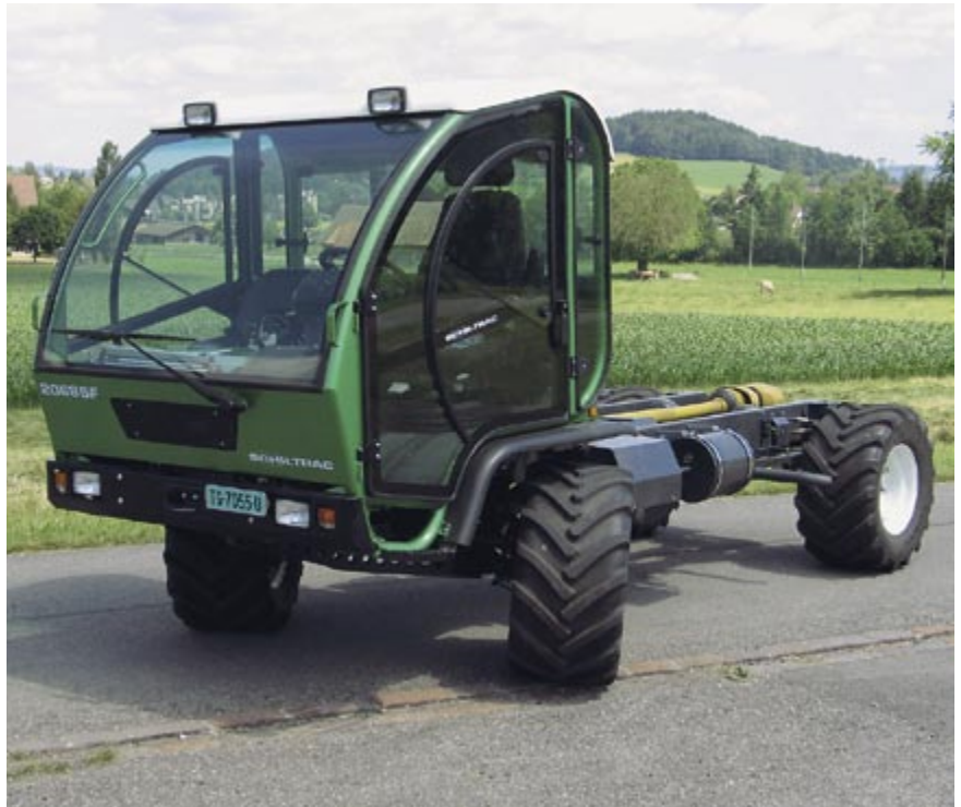
Abb. 14: Transporter SCHILTRAC 2068 SF, 4-Zylinder-Turbomotor mit 65 kW (88 PS), 2-Stufen-Lastschaltgetriebe, Komfortkabine, Achsfederung vorne und hinten, Leergewicht 2660 kg, zulässiges Gesamtgewicht 7000 kg, (Listenpreis Fr. 107 600.-), Testbericht-Nr. 1863/04.
