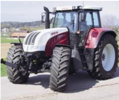
Abb. 12: Traktor STEYR CVT 6170, 6-Zylinder-Turbomotor mit Ladeluftkühlung, 114 kW (155 PS), stufenloses Fahrgetriebe, Fronthydraulik, Vorderachsfederung, Kabinenfederung, Gewicht 7490 kg, (Listenpreis Fr. 180 450.-), Testbericht Nr. 1861/04.
