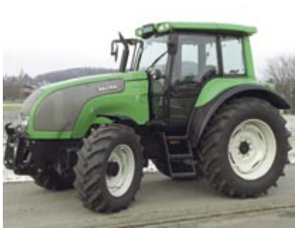
Abb. 8: Traktor VALTRA M130-4, 4-Zylinder-Turbomotor mit Ladeluftkühlung, 95,5 kW (130 PS), 3-Stufen-Lastschaltgetriebe, Fronthydraulik, Vorderachsfederung, Gewicht 5840 kg, (Listenpreis Fr. 127 840.-), Testbericht Nr. 1859/04.
