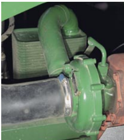
Abb. 5: Der wassergekühlte Ladeluftkühler (zum Beispiel John Deere) ist in den Abmessungen kleiner und die Einbaulage ist annähernd frei wählbar. Die Ladeluft kann nur bis in die Nähe der Kühlmitteltemperatur heruntergekühlt werden.
