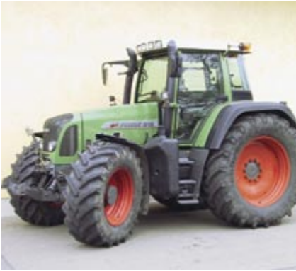
Abb. 11: Traktor FENDT 818 Vario, 6-Zylinder-Turbomotor mit Ladeluftkühlung, 132 kW (180 PS), stufenloses Fahrgetriebe, Fronthydraulik, Vorderachsfederung, Kabinenfederung, Gewicht 7150 kg, (Listenpreis Fr. 204 978.-), Testbericht Nr. 1860/04.
