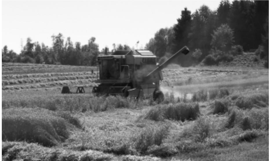
Abb. 12: Beim Mähdrusch von Lagergetreide kann nur mit geringer Arbeitsgeschwindigkeit gefahren werden. Dies erhöht den Zeitbedarf beträchtlich.
