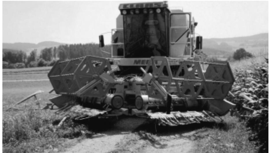
Abb. 21: Durch das hydraulisch einklappbare Schneidwerk beim Mähdrescher lässt sich insbesondere bei kleineren Parzellen der Rüstzeitenanteil reduzieren.
