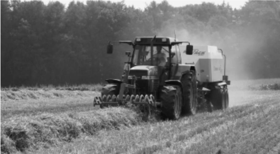
Abb. 16: Quaderballenpressen sind als sehr leistungsfähige Ernteverfahren anzusehen. Sie bilden durch die hervorragende Stapelbarkeit und Raumausnutzung der Ballen die Grundlage für rationelle Transportverfahren.
