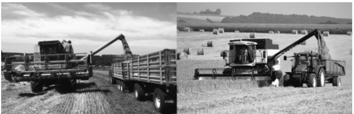
Abb. 13: Das Abtanken auf einen Standwagen ist bei kleineren Parzellen und feuchten Bodenverhältnissen zu empfehlen. Das Abtanken auf einen nebenherfahrenden Überladewagen erhöht die Arbeitsleistung des Mähdruschers.
