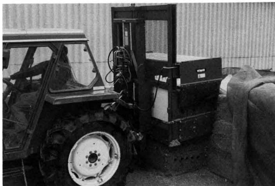
Abb. 6: U-Blockschneider mit Hubgerüst. Investitionsbedarf mit Hubgerüst Fr. 15 000.-, mit Verteiler Fr. 20 000.-. Gewicht leer 1t mit Futter bis 2,3 t.
