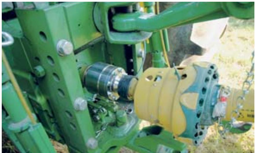
Fig. 7: Un mesureur de couple relève la puissance nécessaire pendant le pressage.
