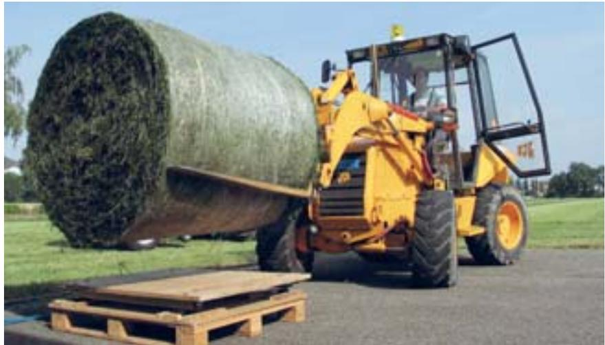
Fig. 8: Pour déterminer le poids des balles, les balles rondes sont déposées sur une plate-forme de pesée à l'issue du pressage.
