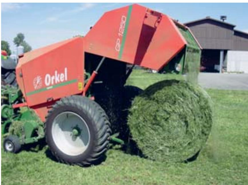
Fig. 1: Lors du pressage du foin et suivant le système de presses, les pertes de fourrage peuvent être comprises entre 0,5 et 2,6 %.
