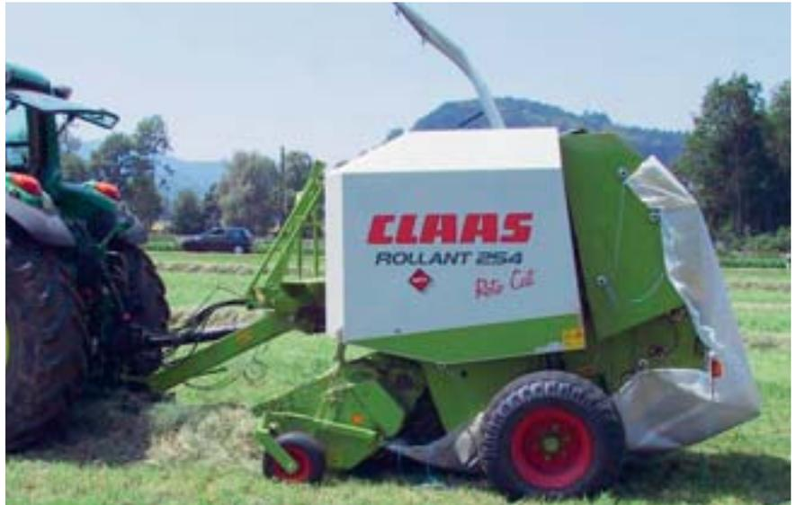
Fig. 5: Un film récupère les pertes par brisure qui surviennent pendant le pressage.
