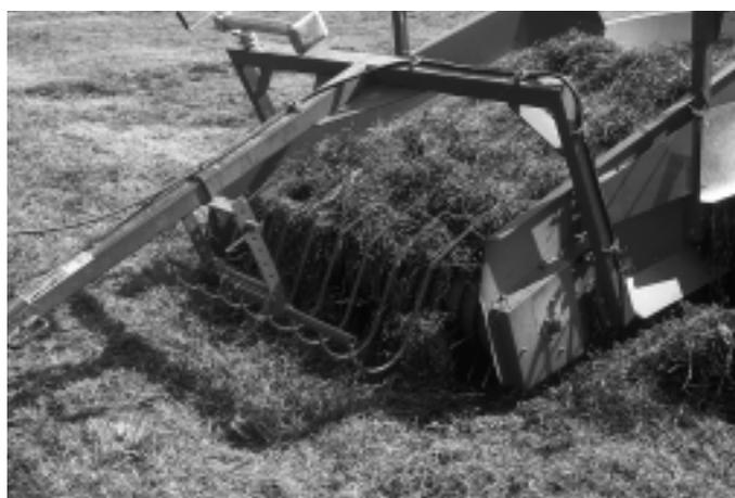
*Fig. 2: Le peigne placé au-dessus du pick-up pour retenir le fourrage a pour but de disposer ce dernier régulièrement et avec ménagement sur le tapis roulant.*
