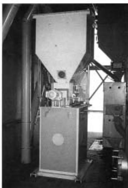
Abb. 11. Automatische Waage für den Kuchenverlad (vorne) und Trommelsiebmaschine zum Reinigen des Rapses vor dem Pressen (hinten).
